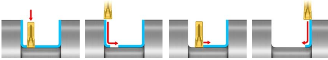
Şekil 2.9. Kanalların ince işlenmesi [13]
