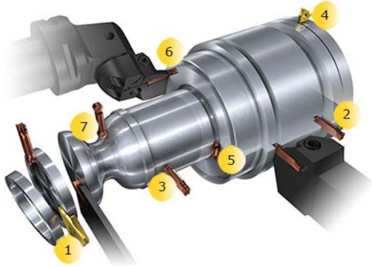
Şekil 2.6. Kanal açma takımlarıyla yapılan işlemler [13]
