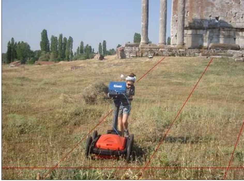
Şekil 3.1: Zeus tapınağı çevresinde yer radarı çalışması (GSSI-SIR 3000 yer radarı sistemi ve 400 Mhz anten).
