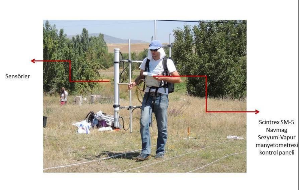
Şekil 3.2: Scintrex SM-5 Navmag Sezyum manyetometresi ile ölçüm alımı.
