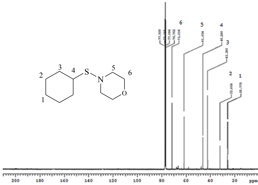
Şekil 3.75. N -(Siklohekziltiyo)morfolin için ^{13}\text{C-NMR} spektrumu ( \text{CDCl}_3 )
