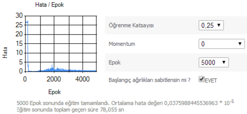
Şekil 3.23. Ağ eğitiminin 5000 öğrenme döngüsü boyunca çalıştırılması ile meydana gelen Hata / Öğrenme döngüsü grafiği
