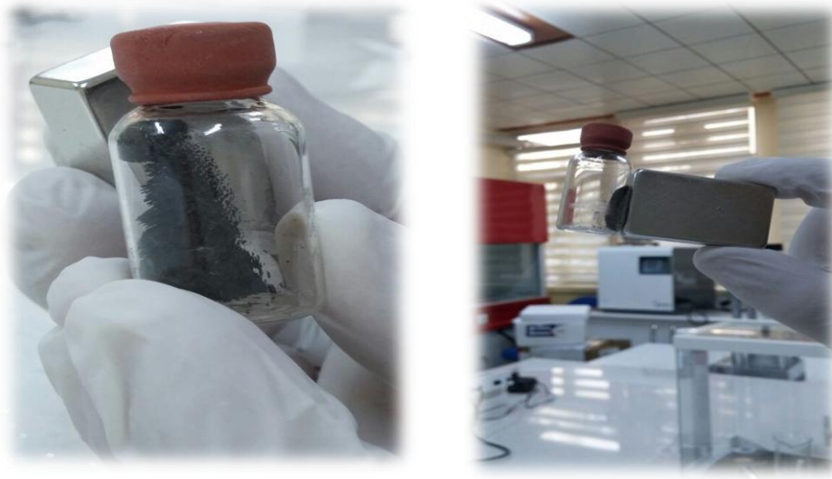
Şekil 5.1 MNP'lerin manyetik alan altındaki hareketi
