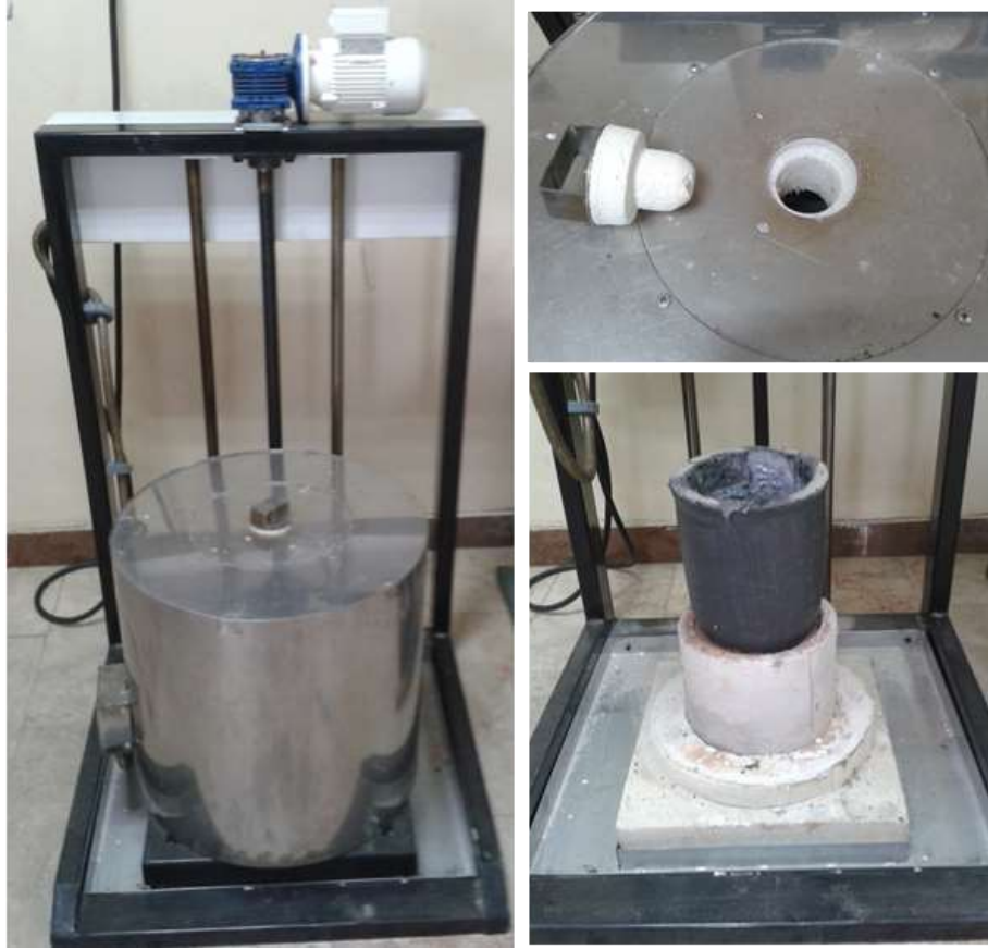
Şekil 3.12. Çan tip elektrik direnç ertitme ocağı.
