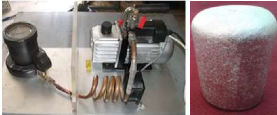
Şekil 3.35. a) RPT cihazı görüntüsü, b) RPT numunesi.
