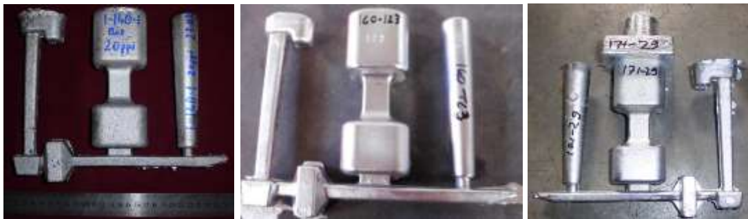
Şekil 3.36. a) Kum kalıp, b) Kokil kalıp, c) Alçak basınçlı döküm numune örnekleri.
