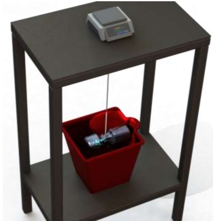
Şekil 3.39. Yoğunluk ölçüm düzeneği şematik görünüşü (Terazinin yerleştiği masada ipin serbestçe hareketi için bir delik bulunmaktadır.)
