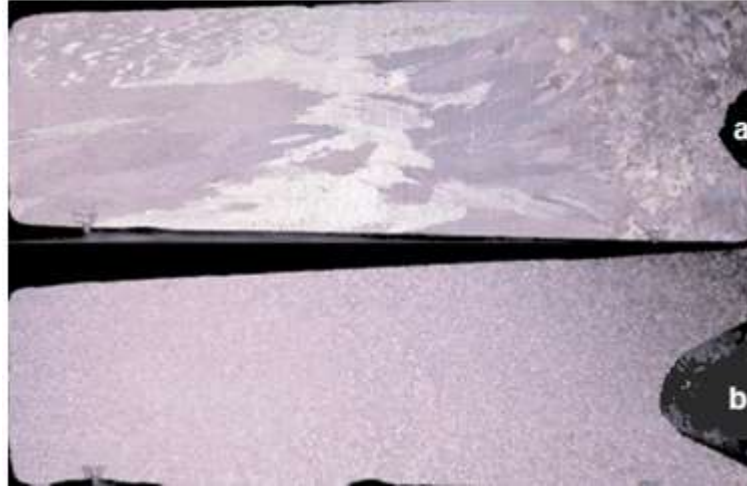
Şekil 2.8. a) Tane inceltilmemiş, (b) Al5Ti1B mastır alaşımı ilaveli alüminyum alaşımasının tane yapıları [34].
