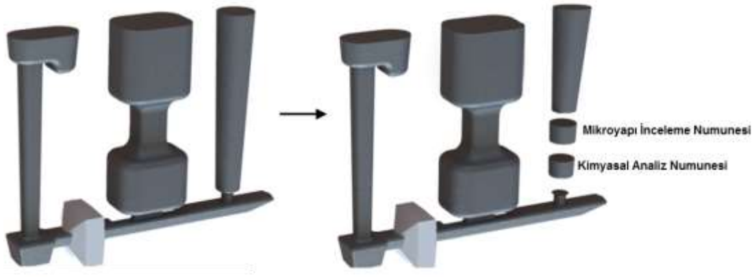
Şekil 3.42. Test numunesinin incelemek üzere kesilmesinin şematik gösterimi.
