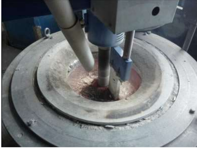
Şekil 2.26. Döner tip rotary gaz giderme [120].
