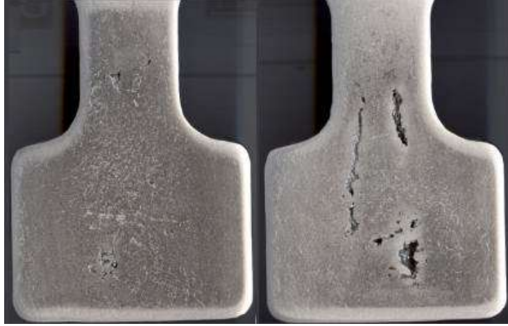
Şekil 4.65. Kesit yüzey incelemelerinde incelenen kesit farklılığından kaynaklanan hataların gösterilmesi.
