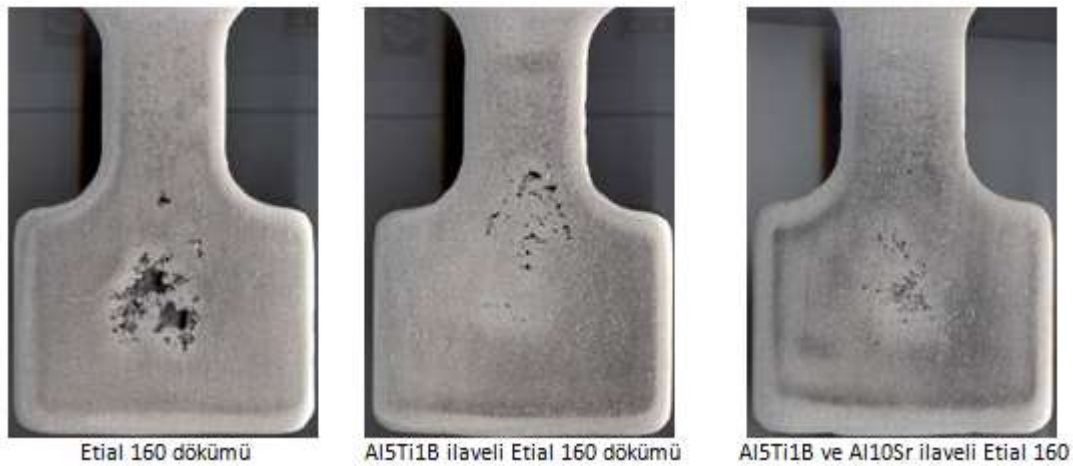
Şekil 4.59. Al5Ti1B ve Al10Sr ilavesinin Etial 160 alaşımında gözenekleşmeye etkisinin kesit yüzey incelemesi.
