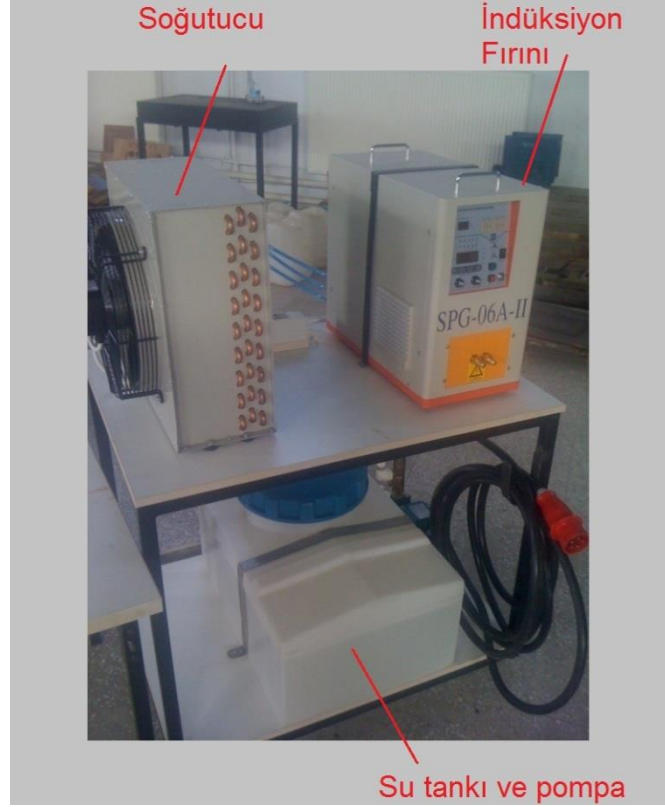
Şekil 3.8. İndüksiyon fırını ve hazırlanan ön ısıtma sistemi
