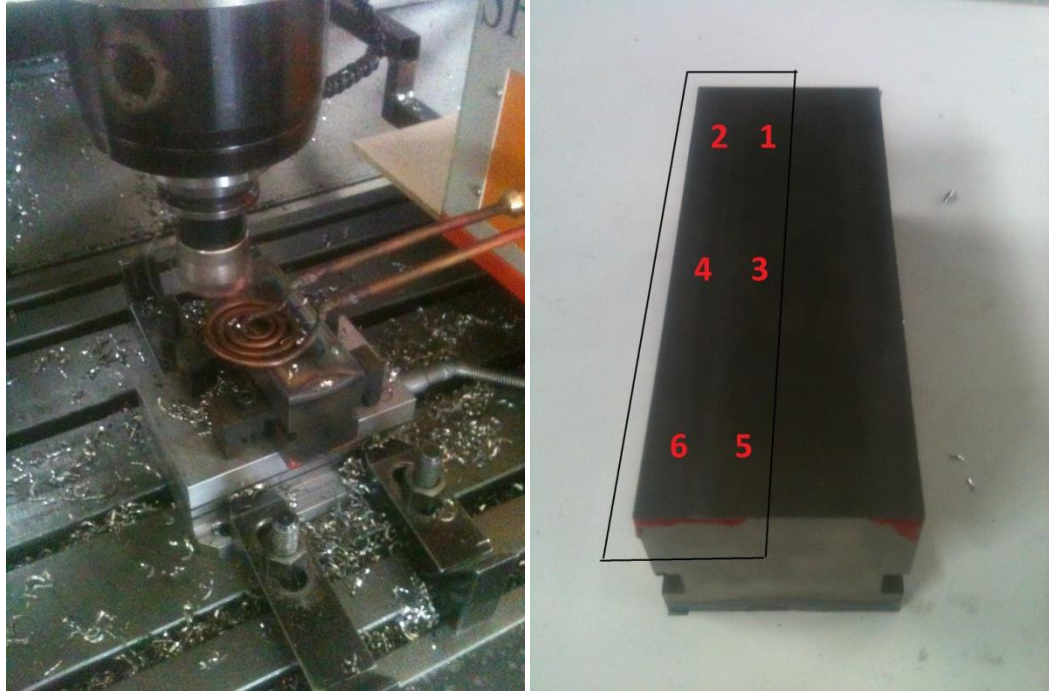
Şekil 3.16. Deneylerde iş parçası yüzey pürüzlülüğünün ölçüldüğü noktalar
