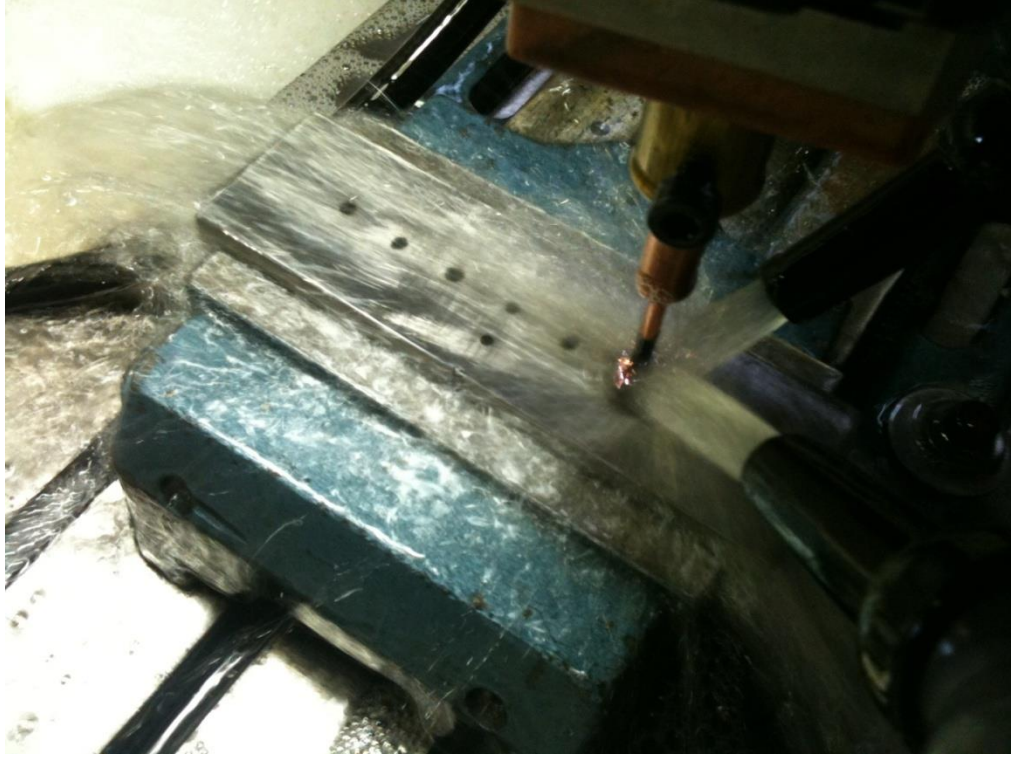
Şekil 3.9. Ön hazırlık deneylerinde kullanılan iş parçasının dalma erozyon tezgâhında hazırlanması
