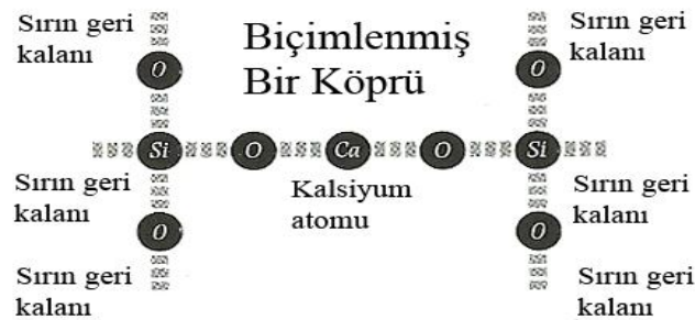
Şekil 2.2 Silika zincirinin biçimlenmiş parçasında bir kalsiyum atomu [26].
