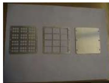
Şekil 4.17: Metal buharlaştırma aşamasında kullanılan maskeler. a) maskelerin katmanları, b) maskelerin üst üste gelmiş ve numunelerin yerleştirilmiş hali.
