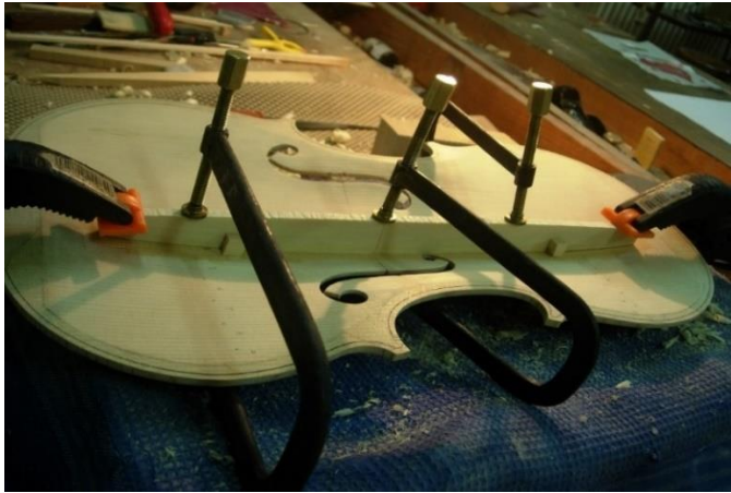
Şekil: 5.58. Bas Balkonun Yapıştırılması
