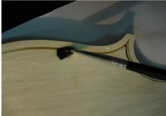
Şekil: 5.35. Filetonun Yapıştırılması
