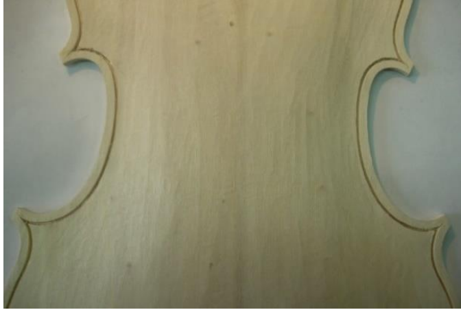
Şekil: 5.28. Fileto Kanalının Tamamlanması
