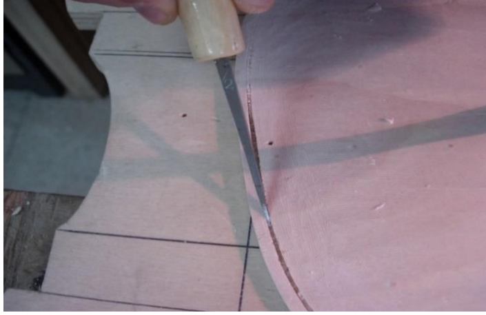
Şekil: 5.27. Fileto Kanalının Açılması
