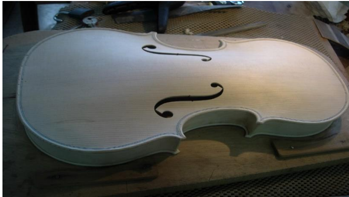
Şekil: 5.61. Bordür Kenarlarının Kırılması
