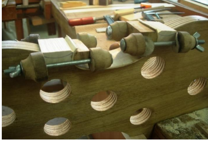
Şekil: 5.7. C Yanlığının Yapıştırılması
