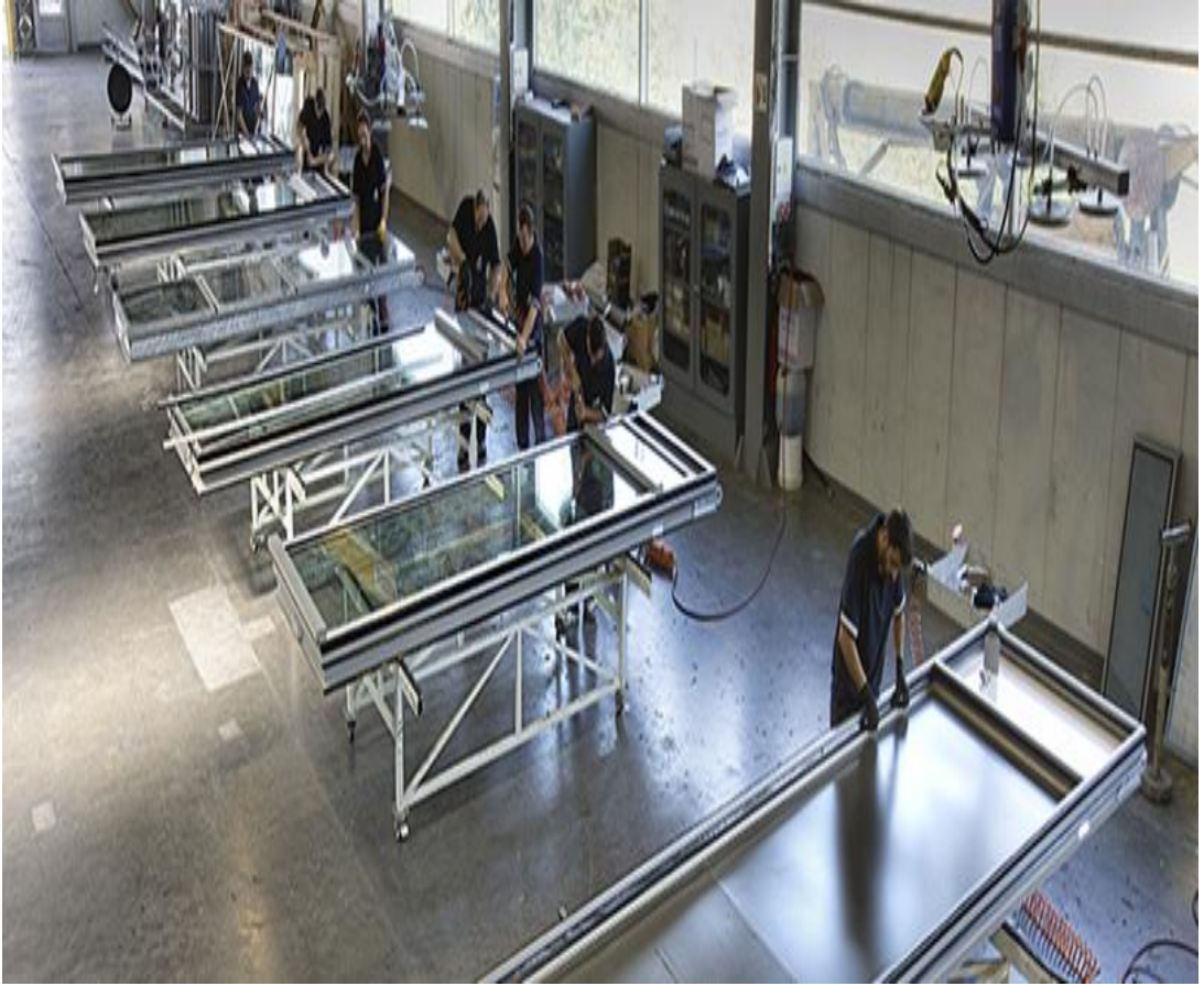
Şekil 2.11: Panel giydirme cephe sistemi imalat aşaması.
