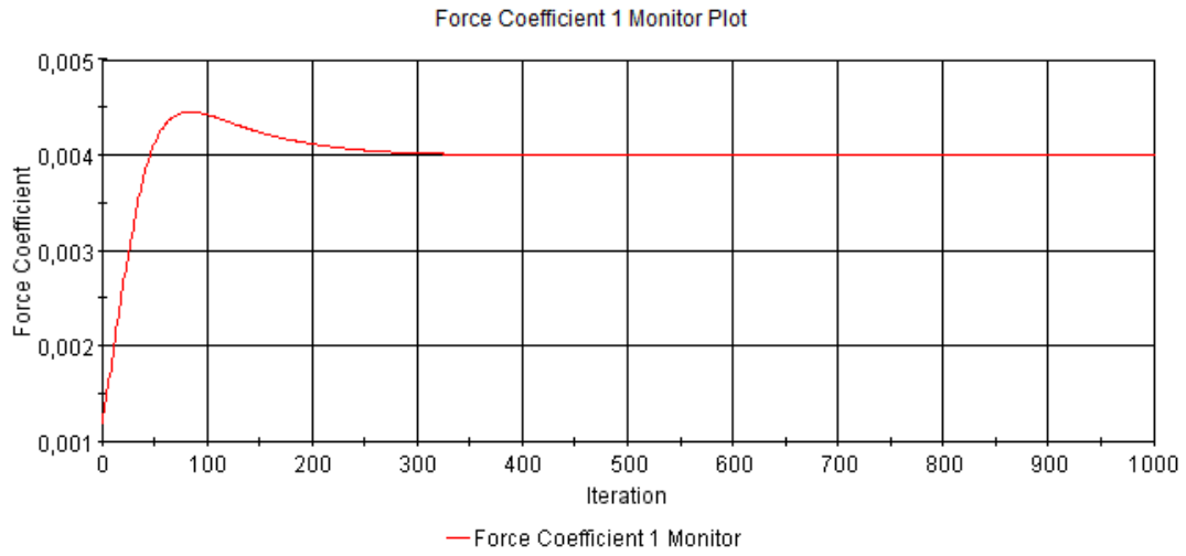
Şekil B. 4 : Pürüzlülük değeri k = 100 \mu m olan plakanın sürtünme direnci katsayısı iterasyonları.
