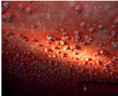
Şekil 2.2 : Barnacles ile kaplanmış gemi dibi (Atlar, 2008).
