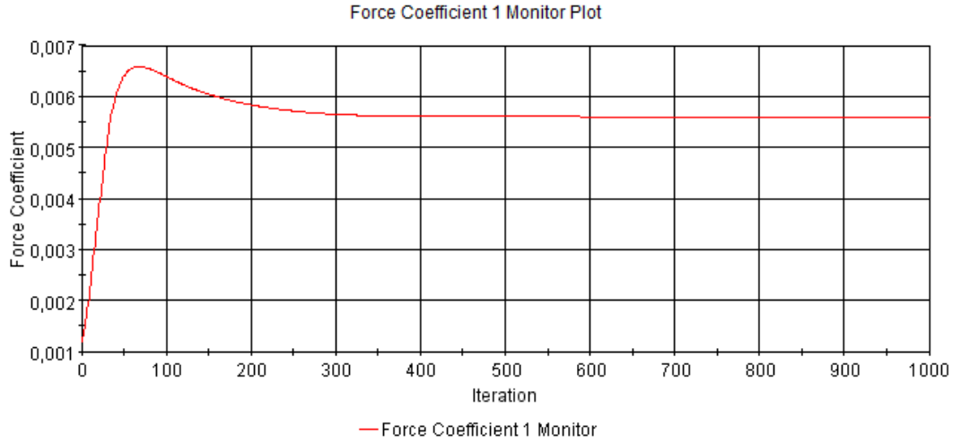
Şekil A. 22 : Pürüzlülük değeri k= 500 \mu m olan plakanın sürtünme direnci katsayısı iterasyonları.
