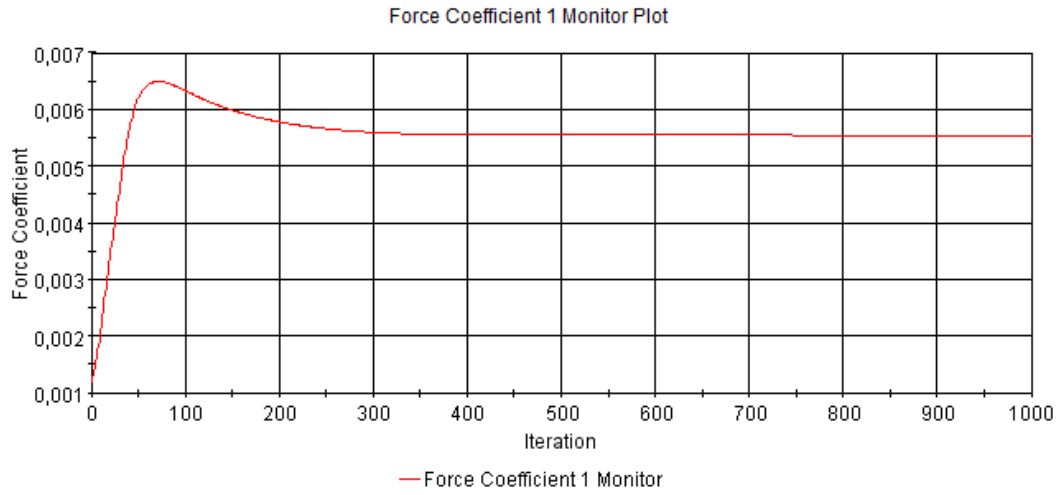
Şekil A. 16 : Pürüzlülük değeri k= 400 \mu m olan plakanın sürtünme direnci katsayısı iterasyonları.
