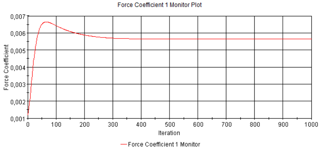
Şekil A. 31 : Pürüzlülük değeri k = 650 \mu m olan plakanın sürtünme direnci katsayısı iterasyonları.
