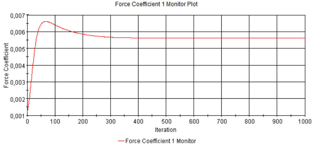
Şekil A. 25 : Pürüzlülük değeri k= 550 \mu m olan plakanın sürtünme direnci katsayısı iterasyonları.
