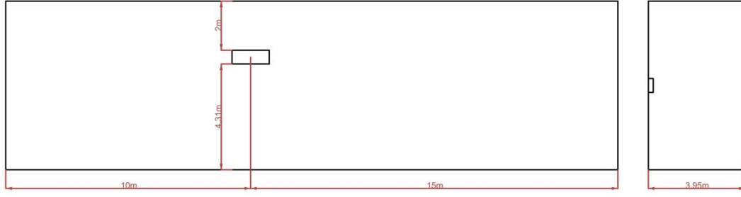
Şekil 5.2 : Sonlu kontrol hacminin boyutları.
