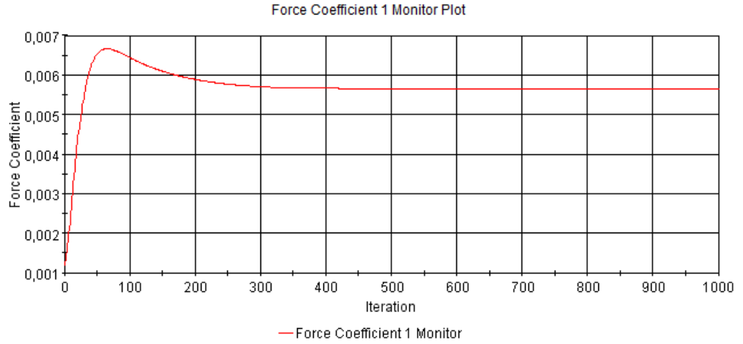
Şekil A. 34 : Pürüzlülük değeri k = 700 \mu m olan plakanın sürtünme direnci katsayısı iterasyonları.
