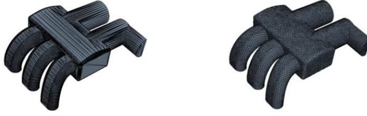
Şekil 5.13 : Surface remesher ile örülmüş bir yüzey ağı örneği (CD-ADAPCO, 2011).
