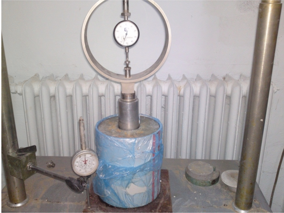
Şekil 3.15: CBR deneyine tabi tutulmuş EPS karışım numunesi ve deney aleti.
