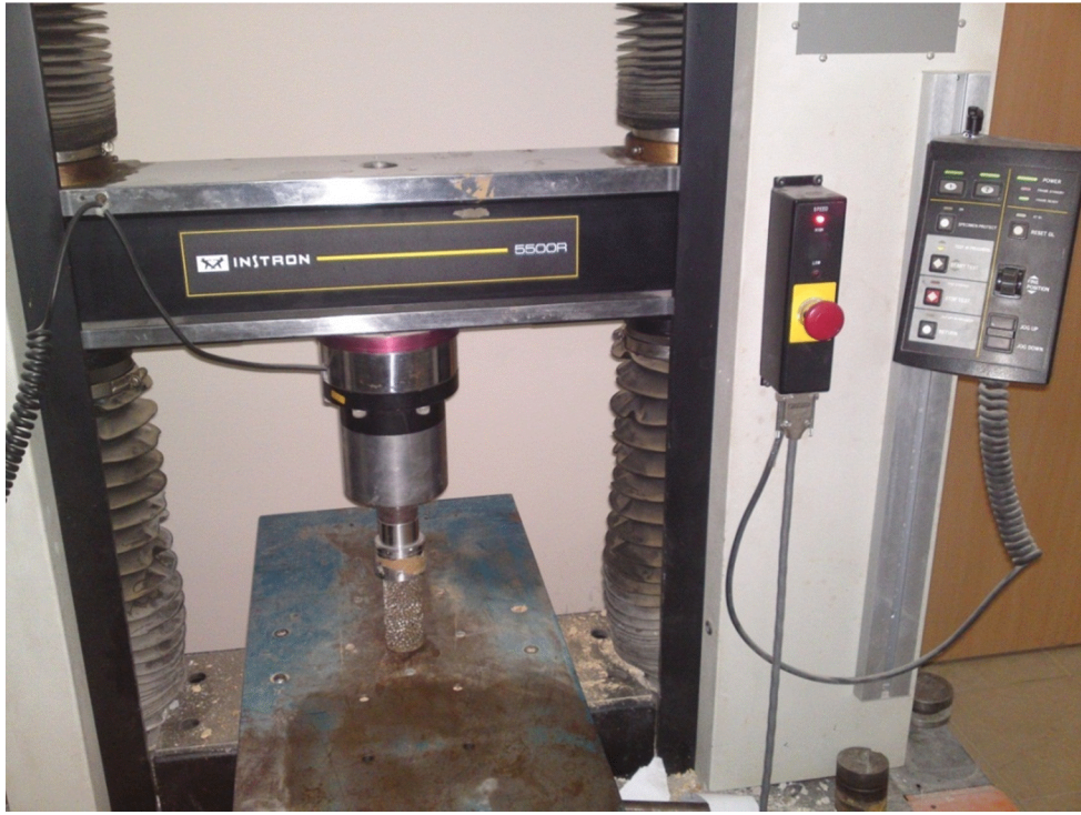
Şekil 3.10: Çimento - EPS - kum karışımında serbest basınç deneyi uygulaması.
