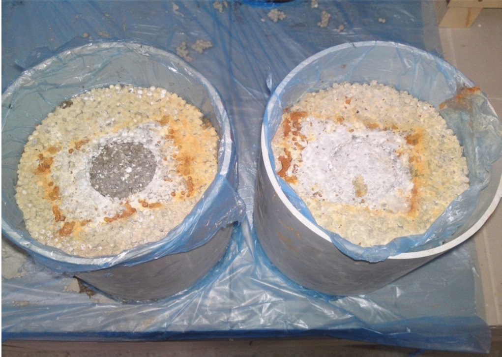
Şekil 3.16: 28 gün nem odasında kalmış ve CBR deneyi yapılmış numuneler.
