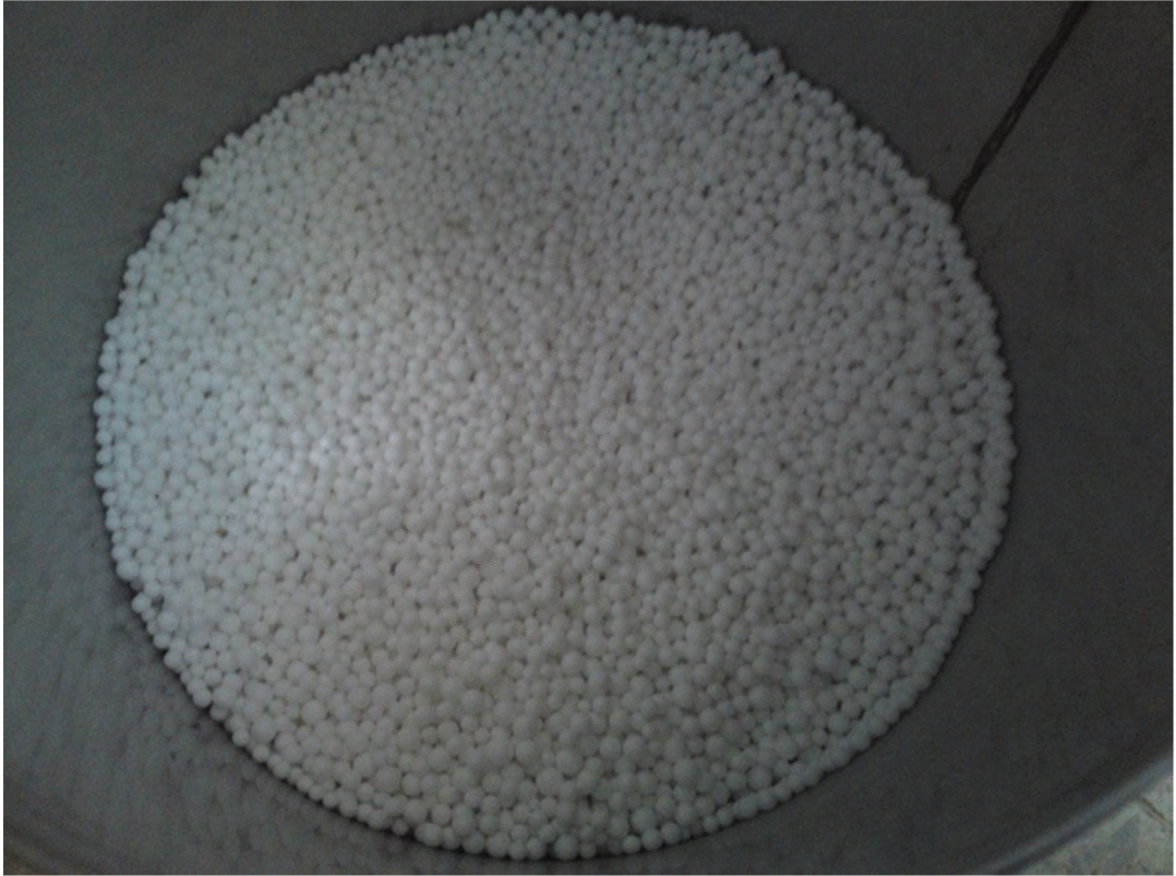
Şekil 3.2: Karışımda kullanılan genişmiş polistiren (EPS) daneleri.
