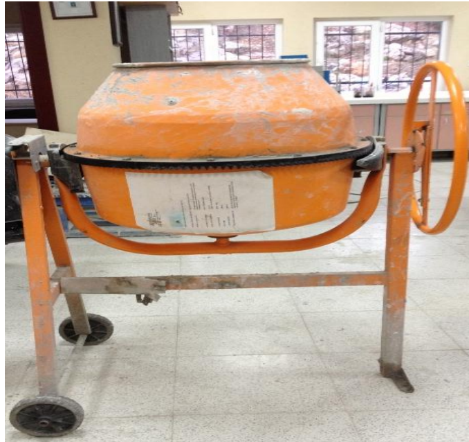
Şekil 3.7. Düz eksenli beton karışım mikseri
