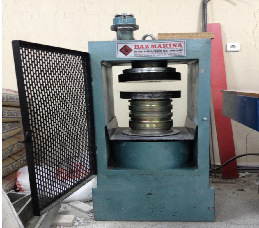
Şekil 3.9. 300 ton kapasiteli tek eksenli basınç presi
