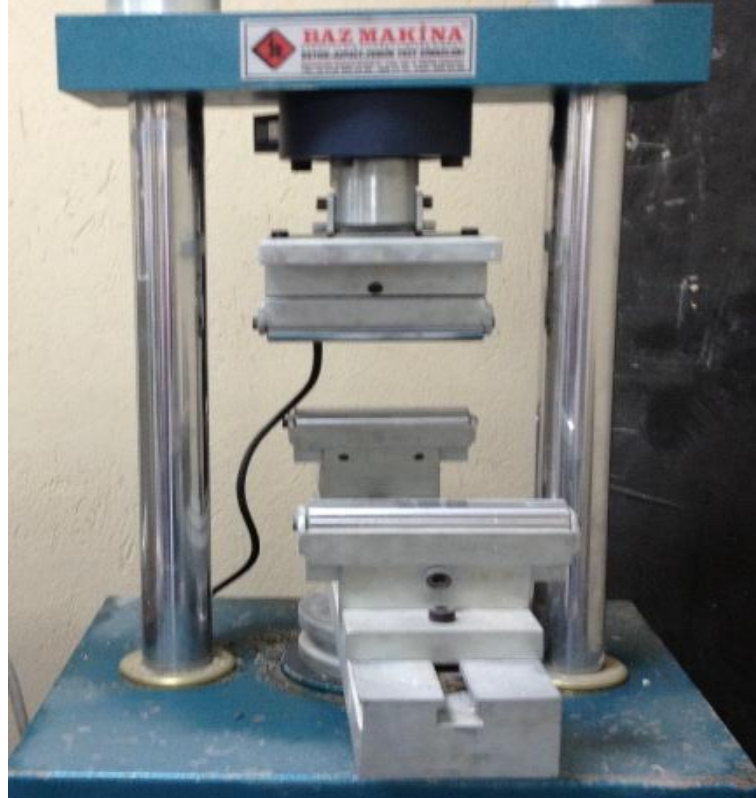
Şekil 3.10. 15 ton kapasiteli eğilme deneyi test cihazı
