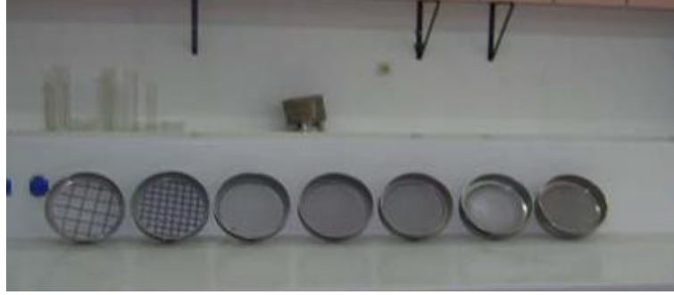
Şekil 3.6. Elek analizi deneylerinde kullanılan standart elekler
