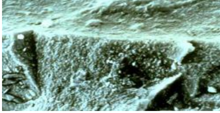
Şekil 3.4. Silis dumanı ihtiva eden beton (Okuyan, 2007)
