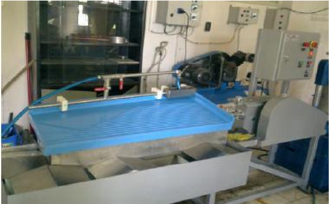
Şekil 3.9. Çukurova Üniversitesinde yapılan parametre deneylerinde kullanılan laboratuvar ölçekli Wilfley tip sallantılı masa.
