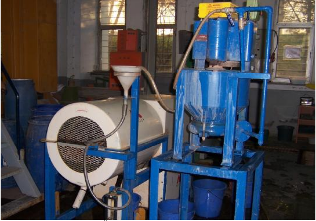
Şekil 4.12. İstanbul Teknik Üniversitesinde deneylerde kullanılan laboratuvar ölçekli C900 tipi MGS cihazı.
