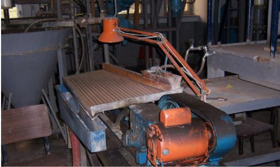
Şekil 4.11. İstanbul Teknik Üniversitesinde proses deneylerinde kullanılan Wilfey tipi sallantılı masa.
