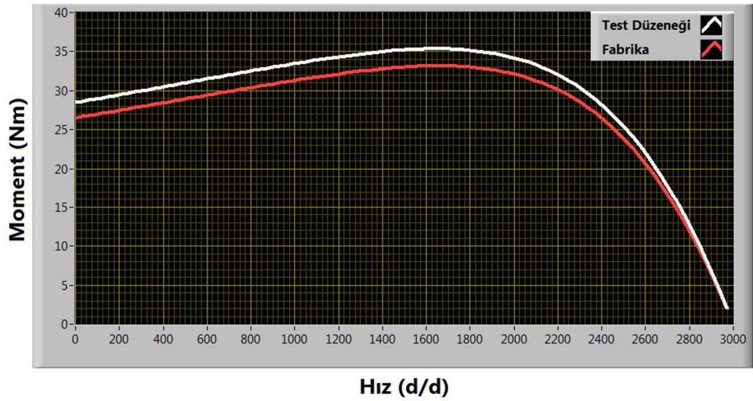
Şekil 4.25. 3 kW asenkron motorun Moment – Hız grafiği
