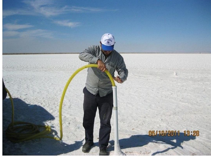
Şekil 4.5. Açılan kuyulardan su numunesi alma işlemi
