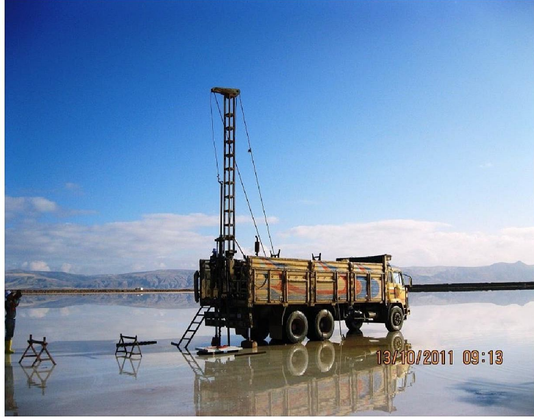
Şekil 4.3. Alt tabakalardan katı numune alabilmek için yapılan sondaj çalışması
