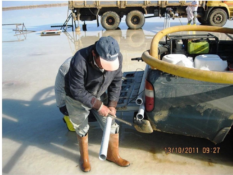
Şekil 4.4. Açılan kuyuları içerisine delikli boru yerleştirme işlemi
