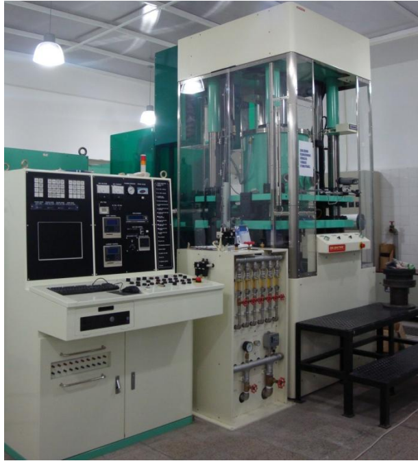
Şekil 7. 1 : Numunelerin üretildiği SPS sistemi
