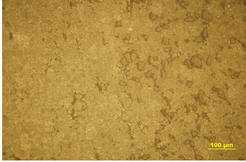
Şekil 3.1. AA7075 ve %10 SiC takviyeli katmanlar arasındaki geçiş bölgesi (X200)
