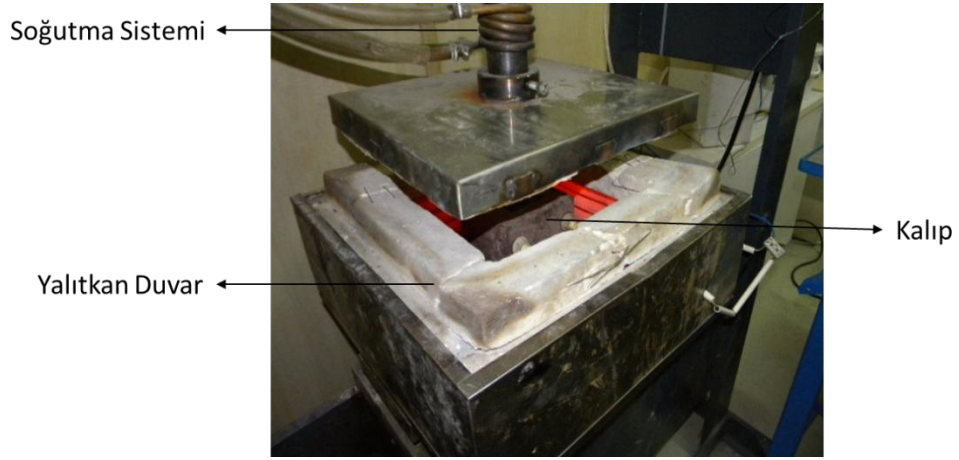
Şekil 2.13. Eş zamanlı olarak gerçekleştirilen presleme ve sinterleme işlemlerinin gösterimi
