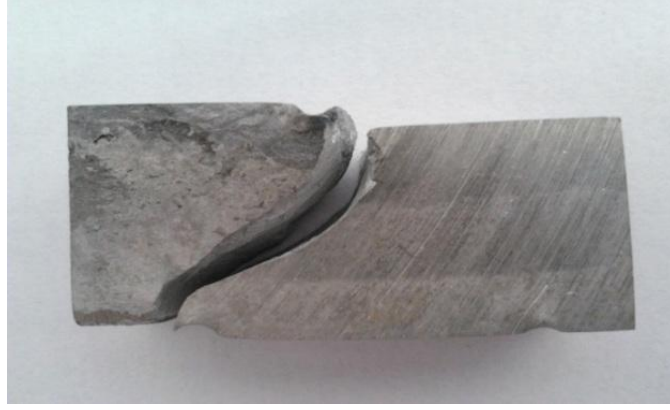
Şekil 3.28. Yaşlandırılmamış düşük Al_2O_3 takviyeli İDM'nin üç nokta eğme testi sonrası görünümü
