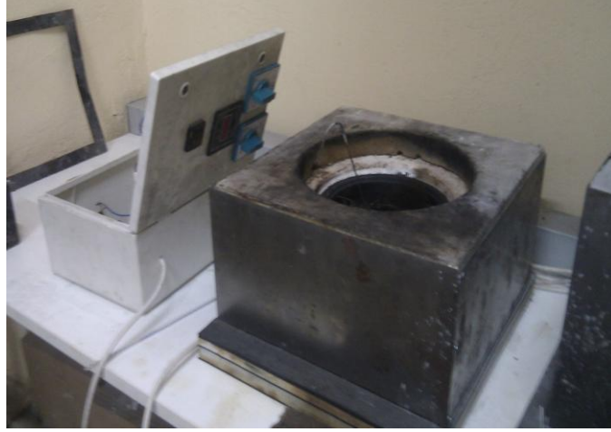
Şekil 2.19. Yaşlandırma işleminin gerçekleştirildiği yağ banyosunun gösterimi
