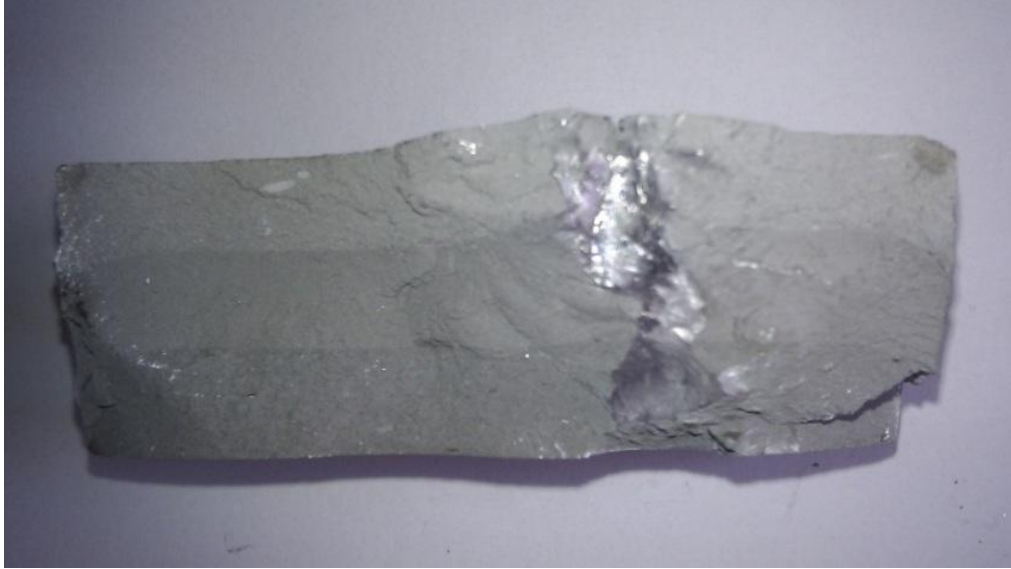
Şekil 3.37. Yüksek SiC takviyeli numunenin kesit görüntüsü
