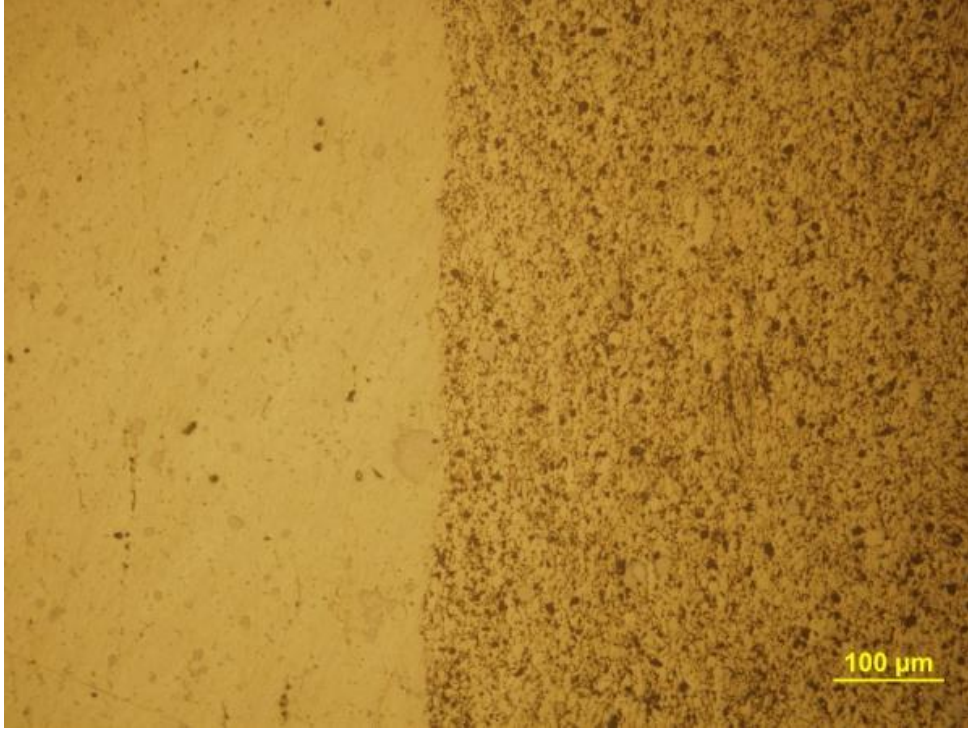
Şekil 3.9. AA7075 alt ve %10 Al 2 O 3 takviyeli orta katmana ait geçiş bölgesi görüntüsü
