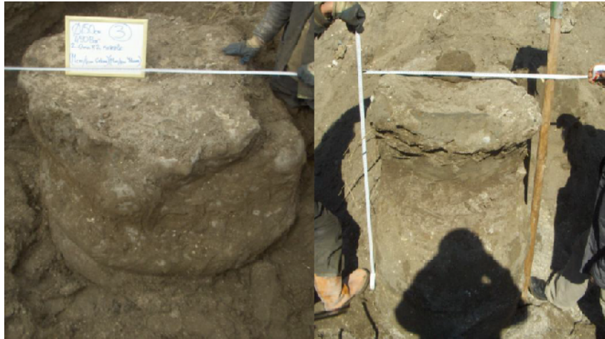
Şekil 2. 18. Samsun’da siltli kum bir formasyonda yapılmış deneme kolonları (Doğanışık, 2010).
