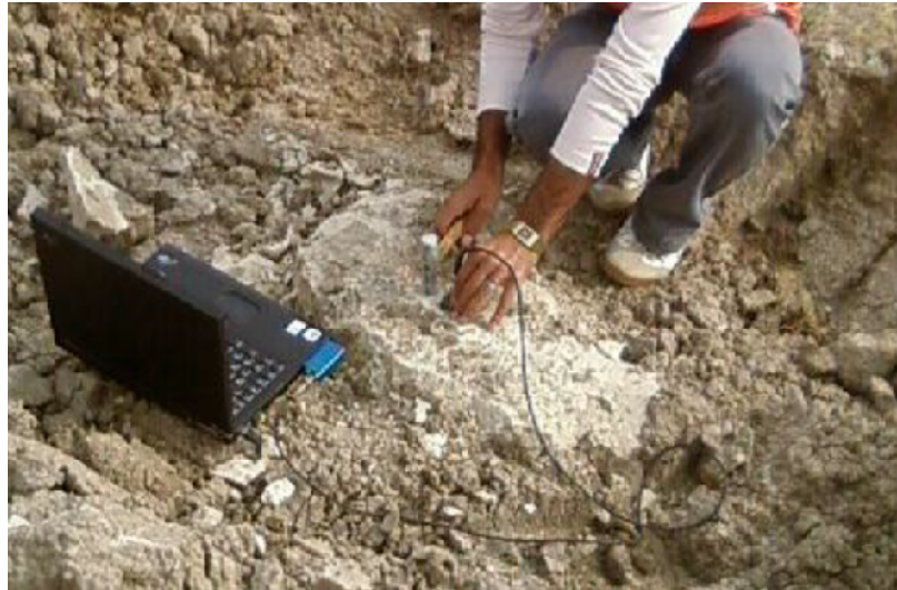
Şekil 2. 26. Jet grout kolonuna yapılan süreklilik testi anı (Doğanışık, 2010)
