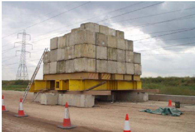
Şekil 2. 24. Statik (sabit) ağırlık kullanılarak yapılan tekil kazık yükleme deneyi (Handley vd., 2006)
