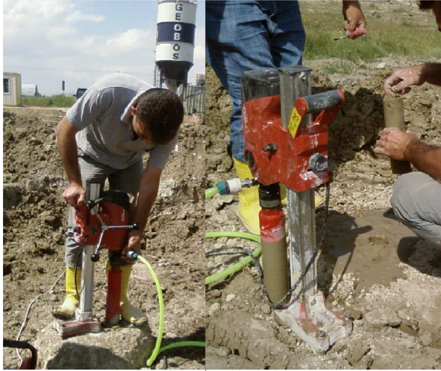
Şekil 2. 19. Jet grout kolonundan alınan karot numune (Doğanışık, 2010)
