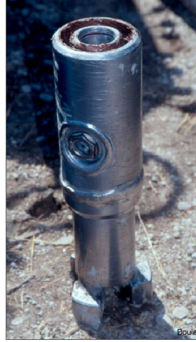
Şekil 2. 1. Delme başlığı (monitör) ve jet enjeksiyon çıkış delikleri (nozül) (Sarı, 2008)
