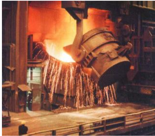
Şekil 3.4 : Yüksek fırından gelen pik demirin BOF'na dökülmesi [5].
