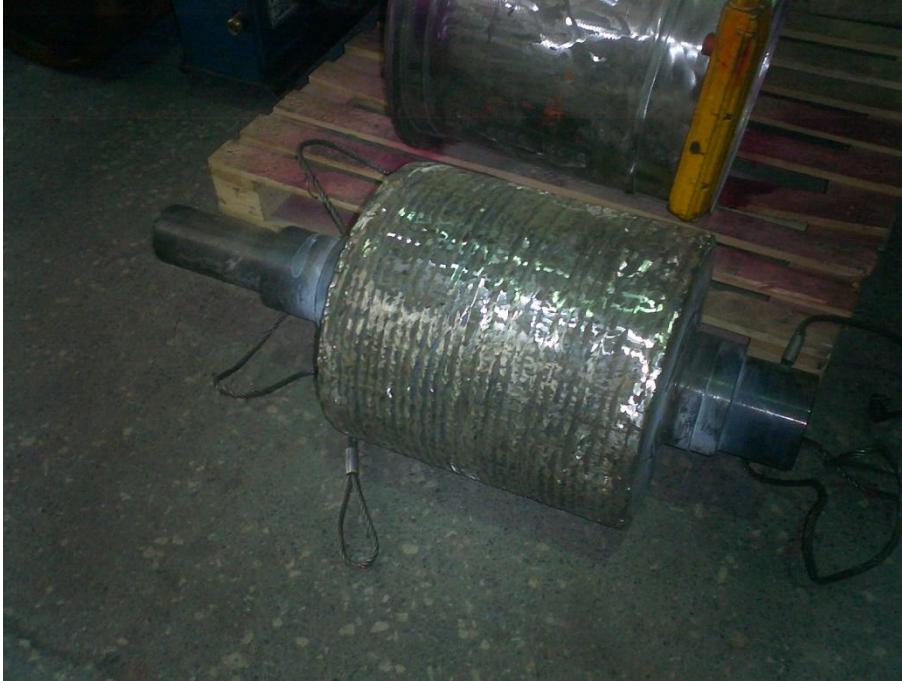
Şekil A.8 : Kaynak ve kaba yüzey temizleme işleminden sonraki görüntü.
