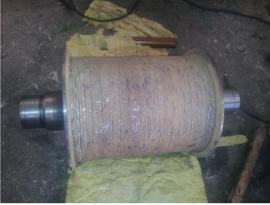
Şekil A.5 : Kaynak ve kontrollü soğutma işlemi bittikten sonraki yüzey görüntüsü.
