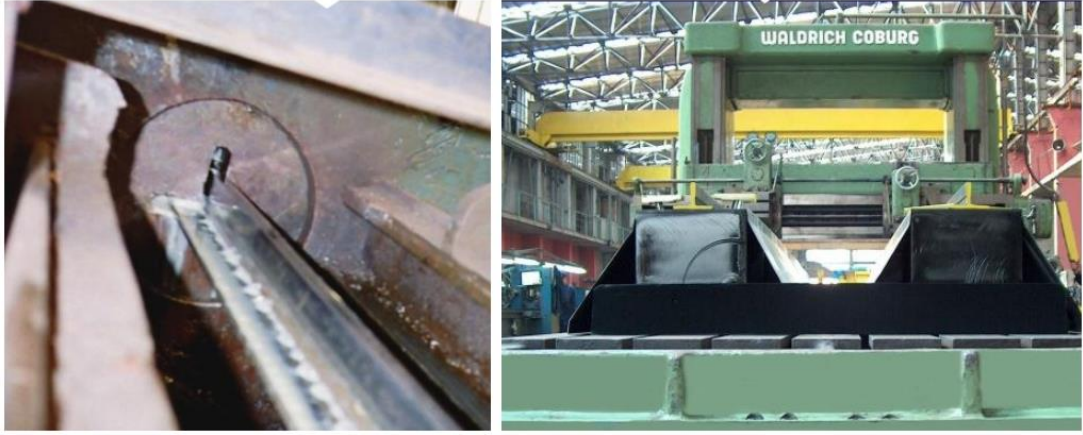
Şekil 3.3 : Rayın soğuk çekme ve talaşlı imalat üretim aşamaları [31].
