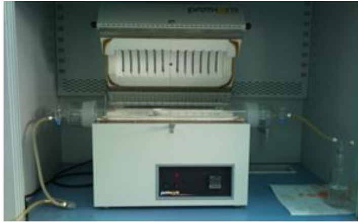
Şekil 5. 4 Split tipi boru fırın reaktör
