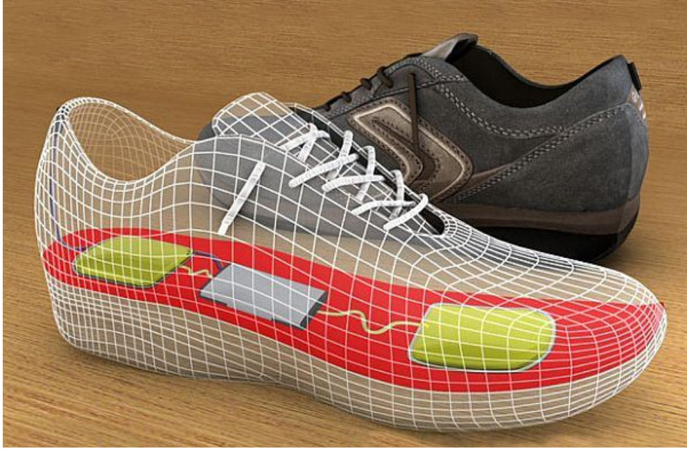
Şekil 1. 21. Pioze sistemin ayakkabıya montajı [55]
