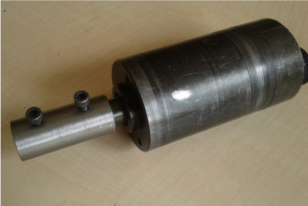
Şekil 2. 12. Bağlantı elemanının hidrolik motora montajı
