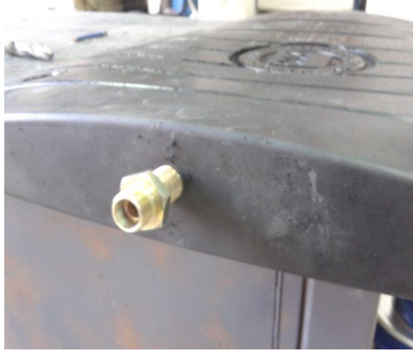
Şekil 2. 4.Hız kesiciye rekor montajı
