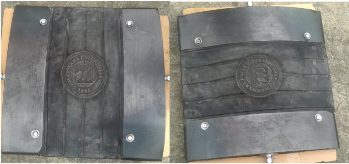
Şekil 2. 3. Hız kesicide basınç kaybını önleyen metaller
