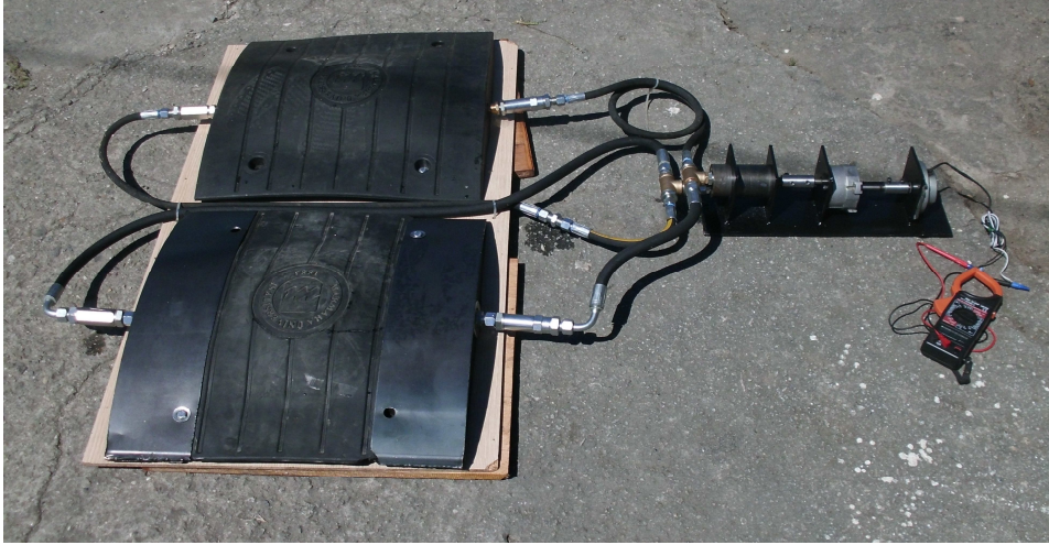
Şekil 2. 34. Çift hız kesicili sistem
