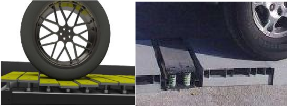
Şekil 1. 20.Doğrusal jeneratörle üretim yapan özel hız kesici tasarımı [9]
