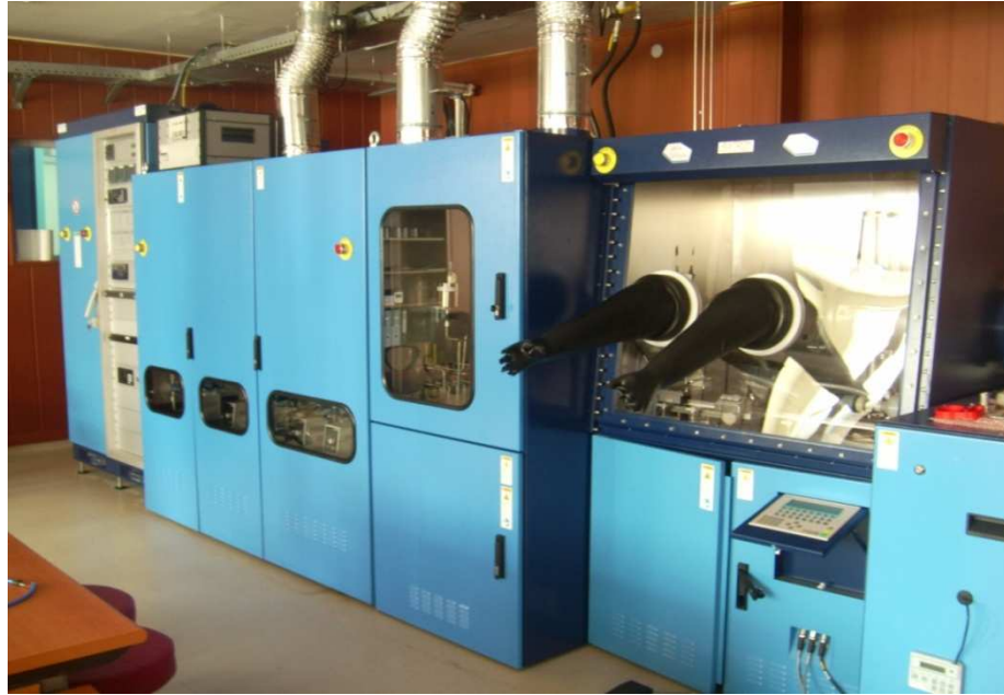
Şekil 2.8 Sivas Cumhuriyet Üniversitesi Nanoteknoloji Laboratuvarında kurulu bulunan MOCVD sistemi
