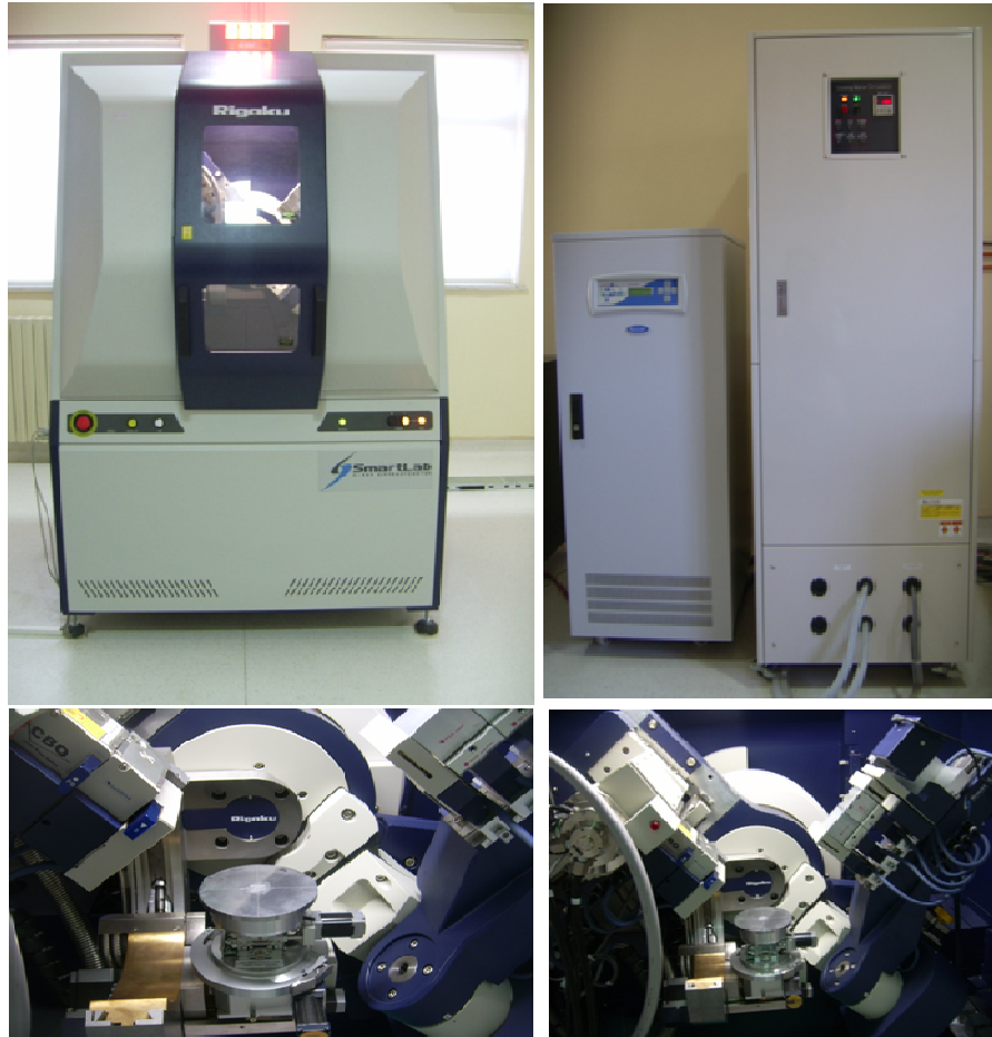
Şekil 4.6 Rigaku SmartLab Yüksek Çözünürlüklü X-ışını Difraktometresi
