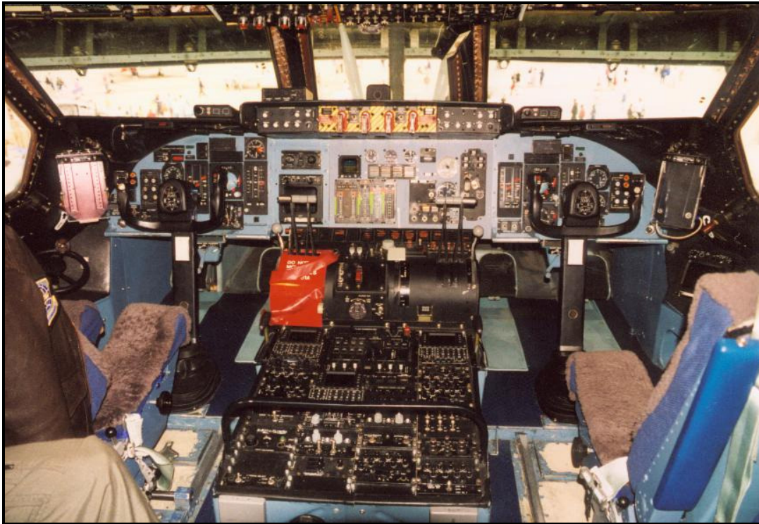
Şekil 3.7: C5-A uçağının geleneksel analog göstergelerle donatılmış hali (Url 7).
