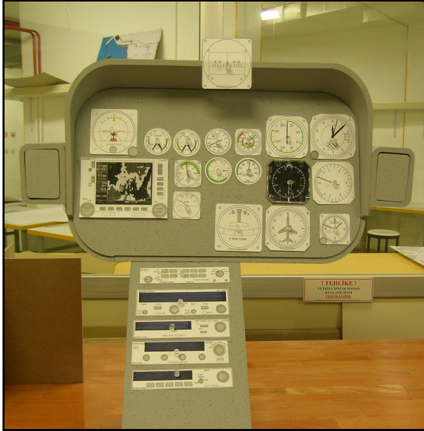
Şekil 6.12 : P3’ün yapmış olduğu kâğıt prototipleme çalışması sonucunda ortaya çıkan gösterge paneli düzenlemesi
