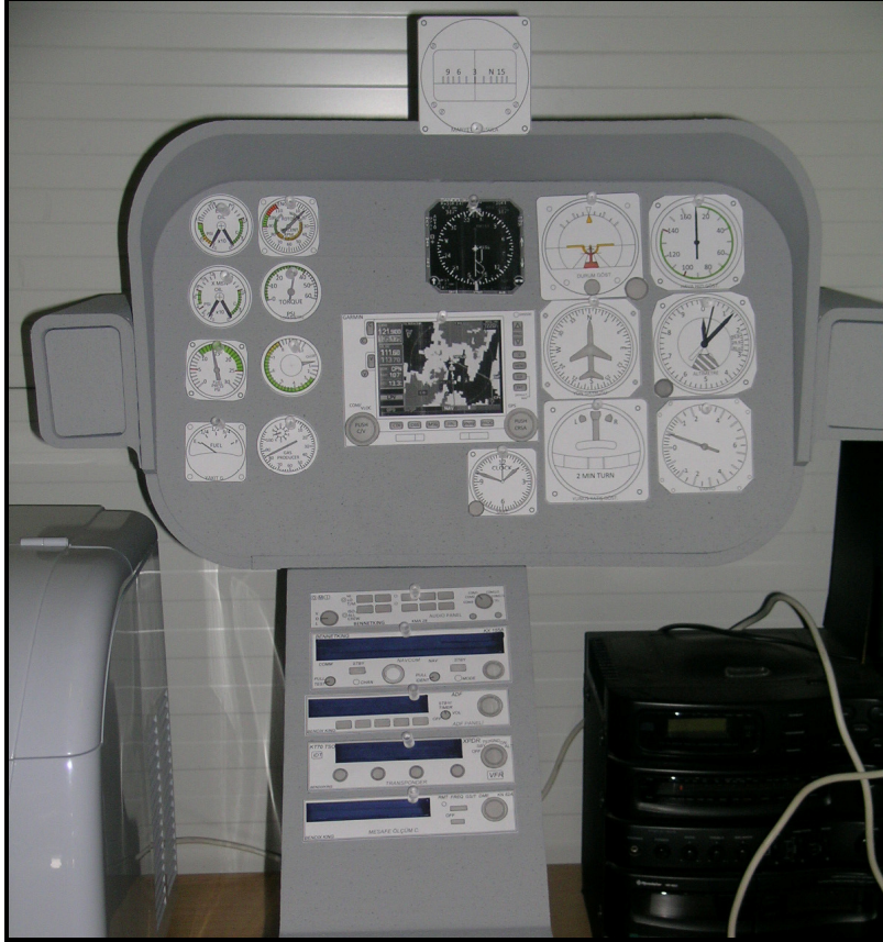
Şekil 6.9: P2'nin yapmış olduğu kağıt prototipleme çalışması sonucunda ortaya çıkan gösterge paneli düzenlemesi
