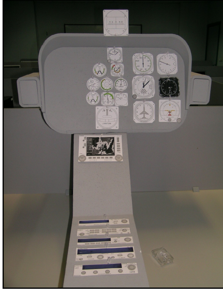
Şekil 6.27: P13'ün yapmış olduğu kağıt prototipleme çalışması sonucunda ortaya çıkan gösterge paneli düzenlemesi
