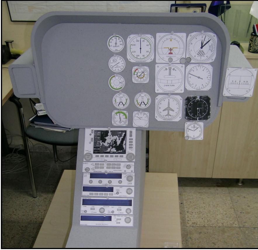
Şekil 6.18: P5’in yapmış olduğu kağıt prototipleme çalışması sonucunda ortaya çıkan gösterge paneli düzenlemesi
