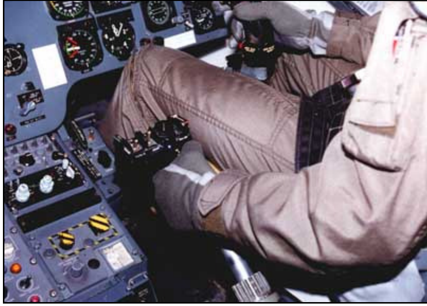
Şekil 3.5: Kolektif kolu (Url 6).
