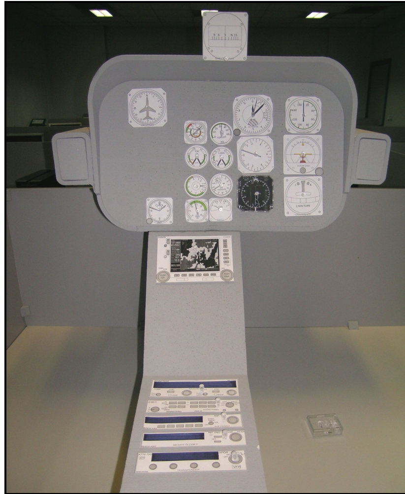
Şekil 6.24: P12’nin yapmış olduğu kağıt prototipleme çalışması sonucunda ortaya çıkan gösterge paneli düzenlemesi
