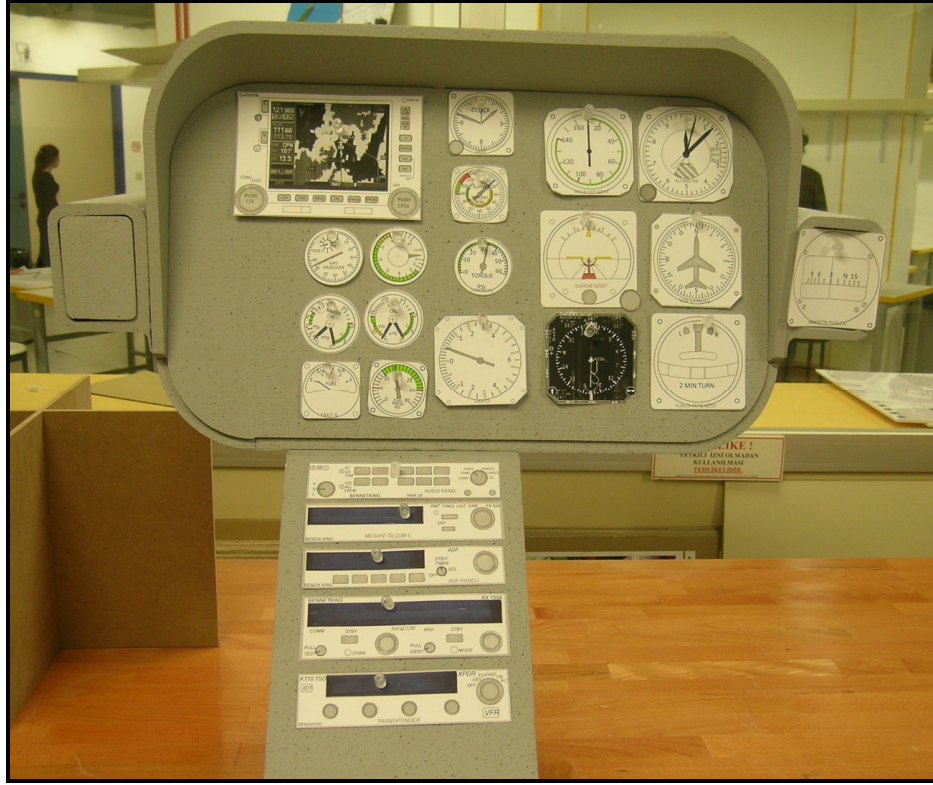
Şekil 6.15: P4'ün yapmış olduğu kâğıt prototipleme çalışması sonucunda ortaya çıkan gösterge paneli düzenlemesi
