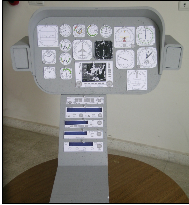
Şekil 6.30: P14'ün yapmış olduğu kağıt prototipleme çalışması sonucunda ortaya çıkan gösterge paneli düzenlemesi
