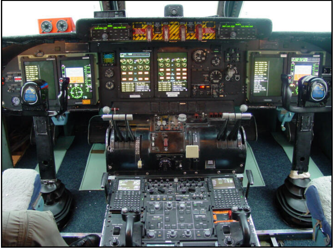
Şekil 3.8: C5-A uçağının glas pilot kabini olarak donatılmış hali (Url 8).
