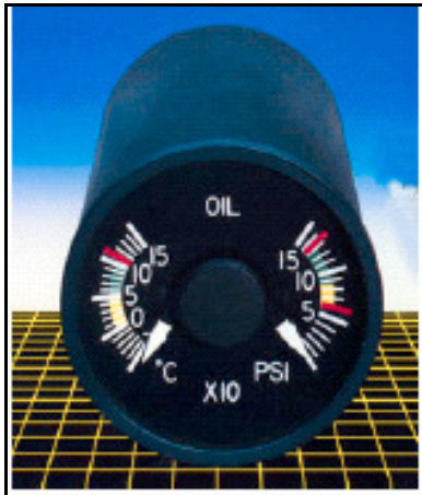
Şekil A 18 : Tranmisyon yağ sıcaklığı ve basıncı göstergesi
