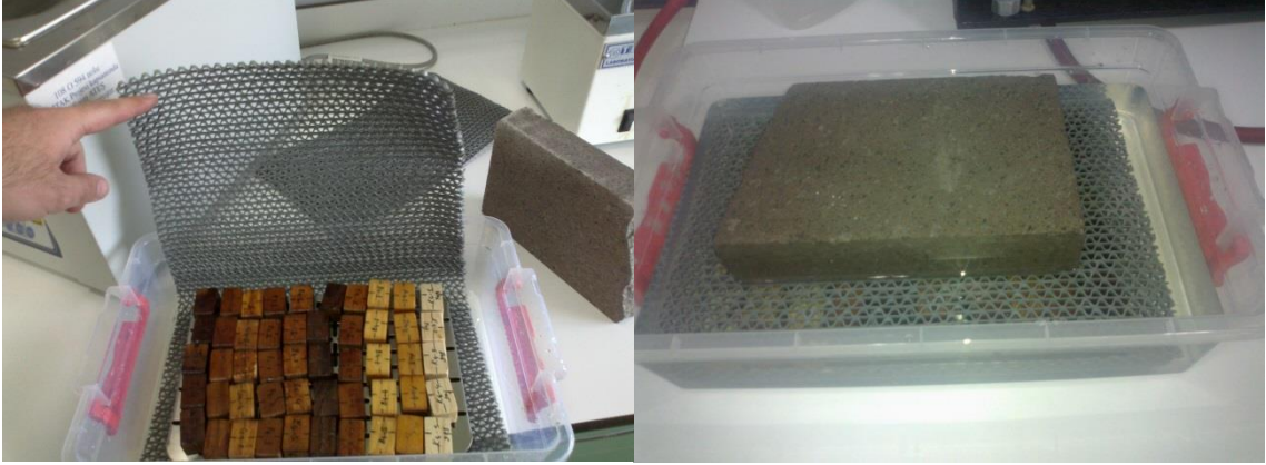
Şekil 3.4. Su Alma ve Odunda Hacimsel Şişme Deneyi
