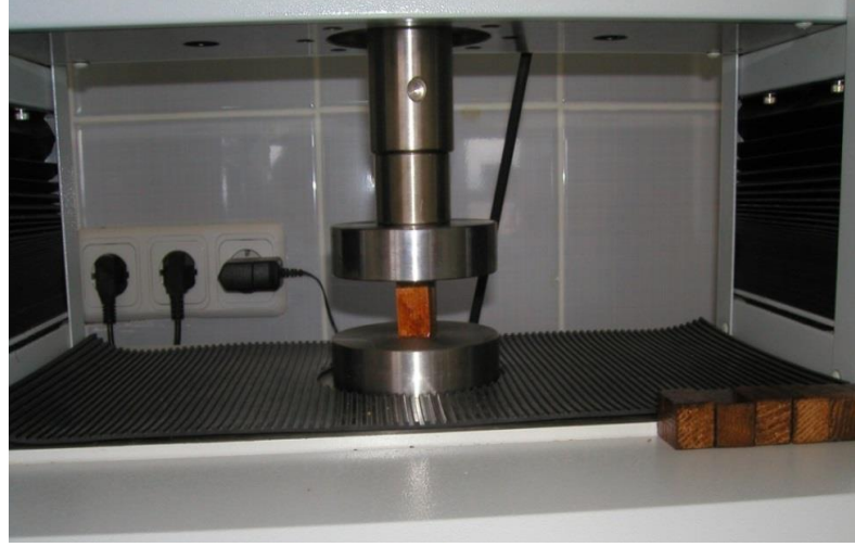
Şekil 3.6. Liflere Paralel Basınç Direnci Uygulaması
