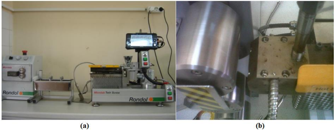
Şekil 3.1: Çalışmada kullanılan laboratuvar tipi çift vidalı ekstrüder (a) ve film numunesi elde etmek için kullanılan yarıklı kalıp (b).
