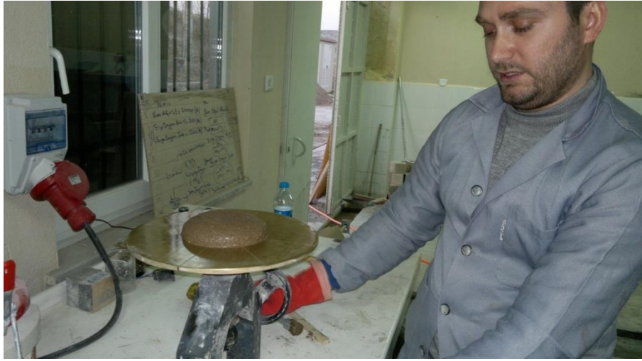
Şekil 3.10. Yayılma tablasında kıvam tayini deneyinin yapılışı
