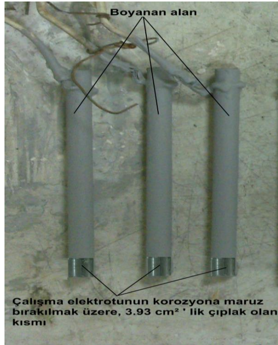
Şekil 3.26. Ø10x10 mm'lik alan hariç, geriye kalan kısmı antipas boya ile boyanan çelik çalışma elektrotları
