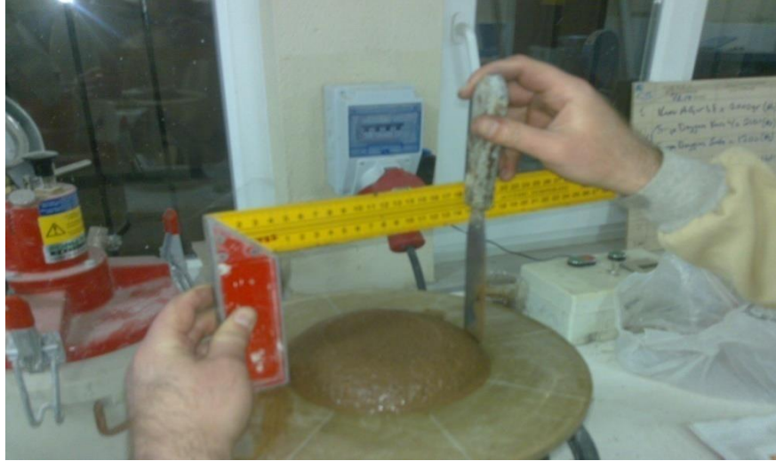
Şekil 3.11. Taze harç düşürüldükten sonra yayılmanın ölçülme işlemi
