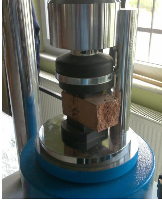
Şekil 3.17. Cihazın basınç test aparatı bölümünde basınç mukavemeti deneyi yapılırken
