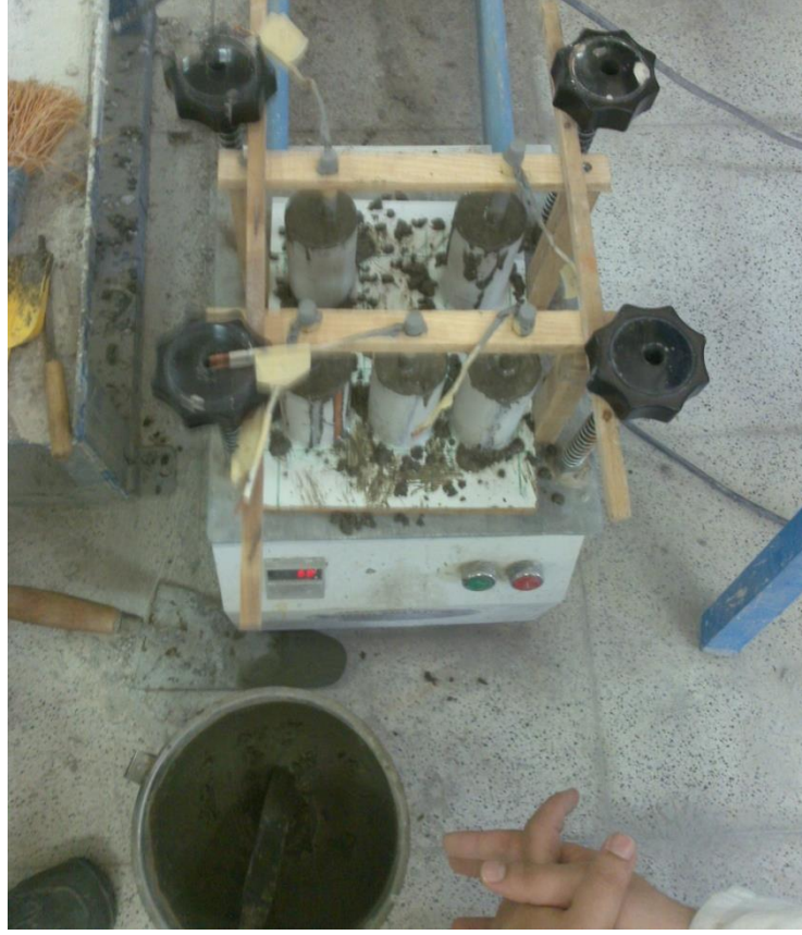
Şekil 3.30. Sarsma tablasında kalıplara harç dolduruluşu ve sıkıştırılması
