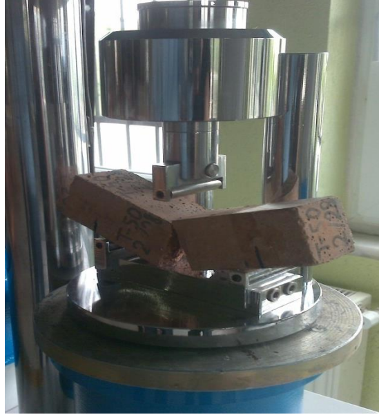
Şekil 3.16. Cihazın eğilme test aparatı bölümünde eğilme deneyi yapılmış numune
