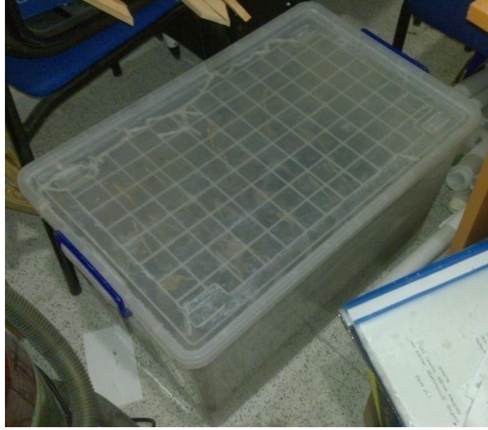
Şekil 3.34. NaCl çözeltili kür havuzunun kapağı kapatılarak korozyon ortamında bekletilmesi
