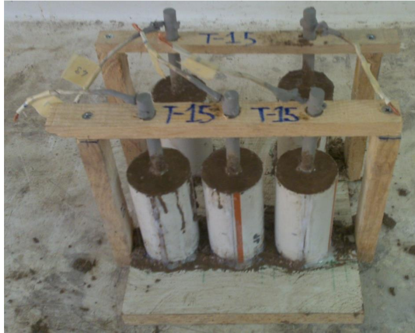
Şekil 3.31. Harçlara doldurulan kalıpların görünüşü
