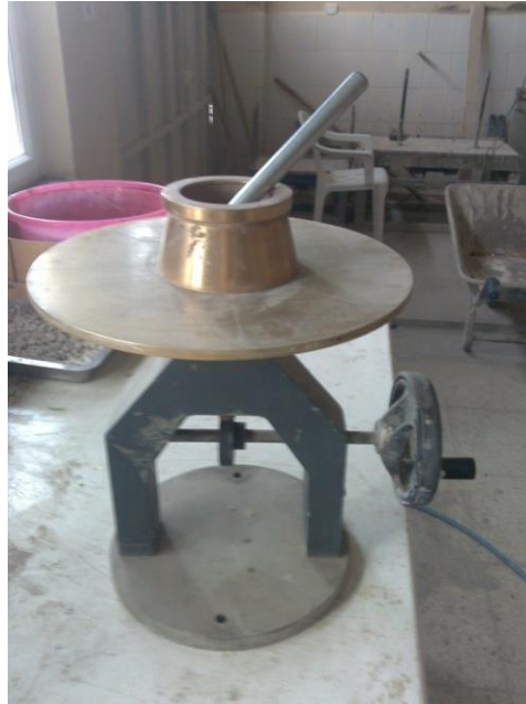
Şekil 3.9. Taze harç kıvam deneylerinin yapıldığı yayılma tablası
