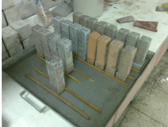
Şekil 3.21. Numuneler üzerinde kılcal su emme deneyi yapılırken
