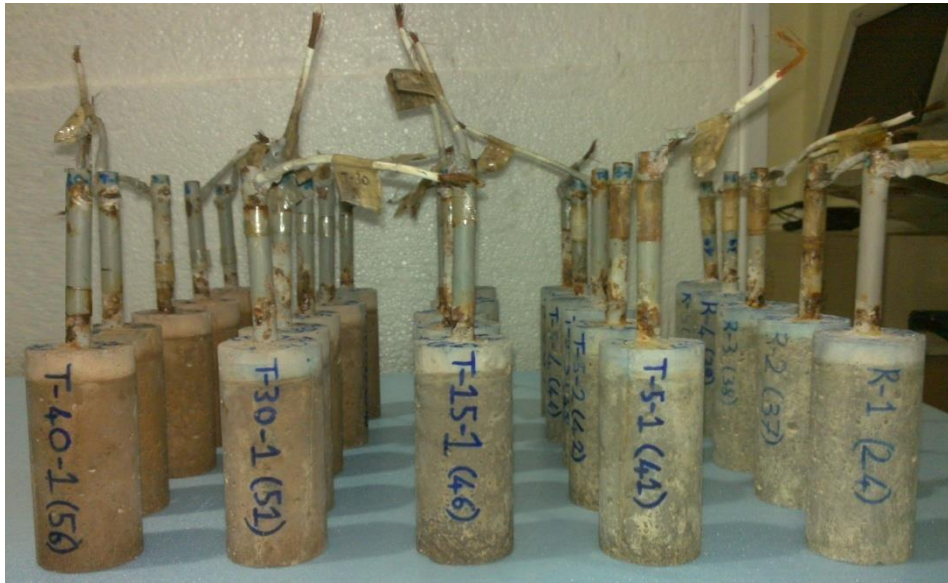
Şekil 3.35. Çözeltili ortamda bekletilen korozyon numunelerinin görünümü
