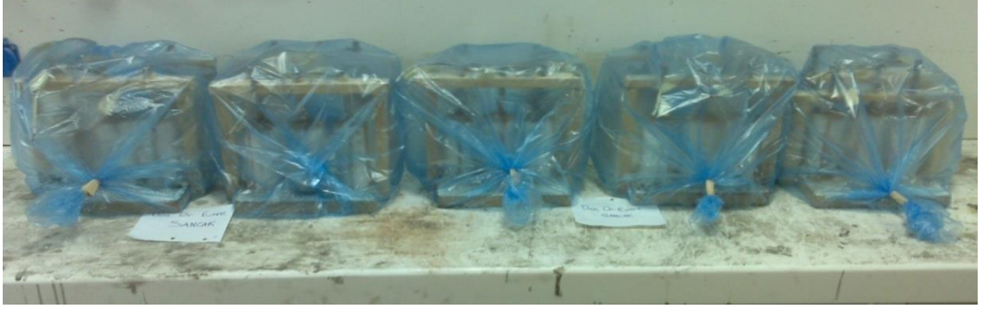
Şekil 3.32. Örneklerin nemi kaybetmelerini önlemek üzere plastik örtüye sarılmış halde bekletilmesi (24 saat)
