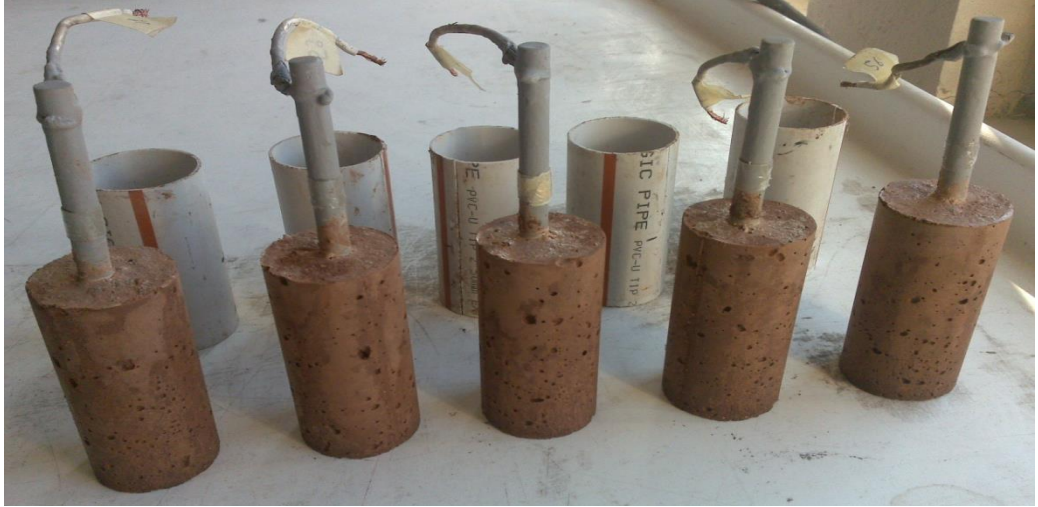
Şekil 3.33. Silindirik kalıplarından çıkarılan numunelerin görünüşleri
