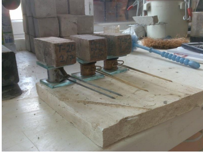
Şekil 3.6. Üstüne ilave ağırlıkları konulmuş Le Chatelier kalıpları
