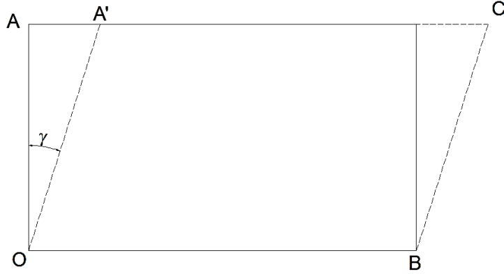
Şekil 4.10 : Kayma açısının geometrik gösterimi.
