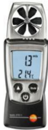
Şekil 7.2 : Şişli istasyonunda hava hızı ölçümü için kullanılan anemometre
