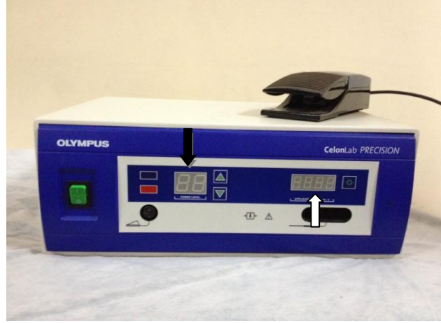
Resim 8. Bipolar CelonLab Precision radyofrekans enerji kontrol ünitesi, ünite üzerinde uygulanan güç (siyah ok) ve uygulama zamanı (beyaz ok) gösterilmekte
