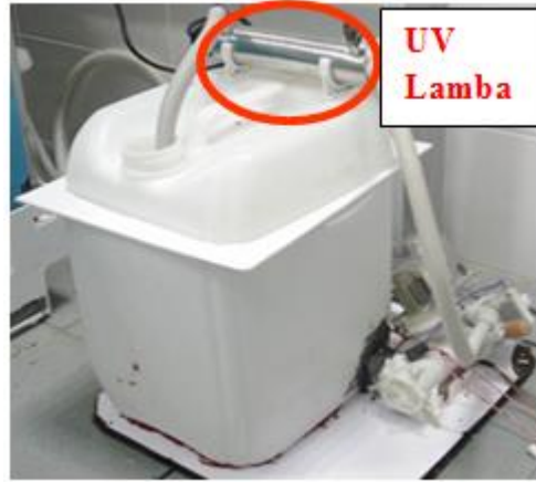
Şekil 3.19 : UV dezenfeksiyon ünitesi deney düzeneği.
