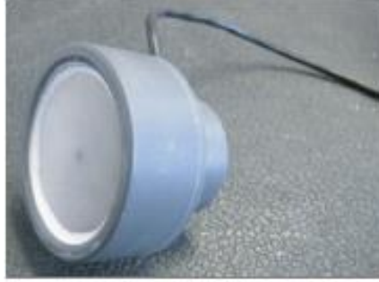
Şekil 3.6 : HIFU tipi transduser.
