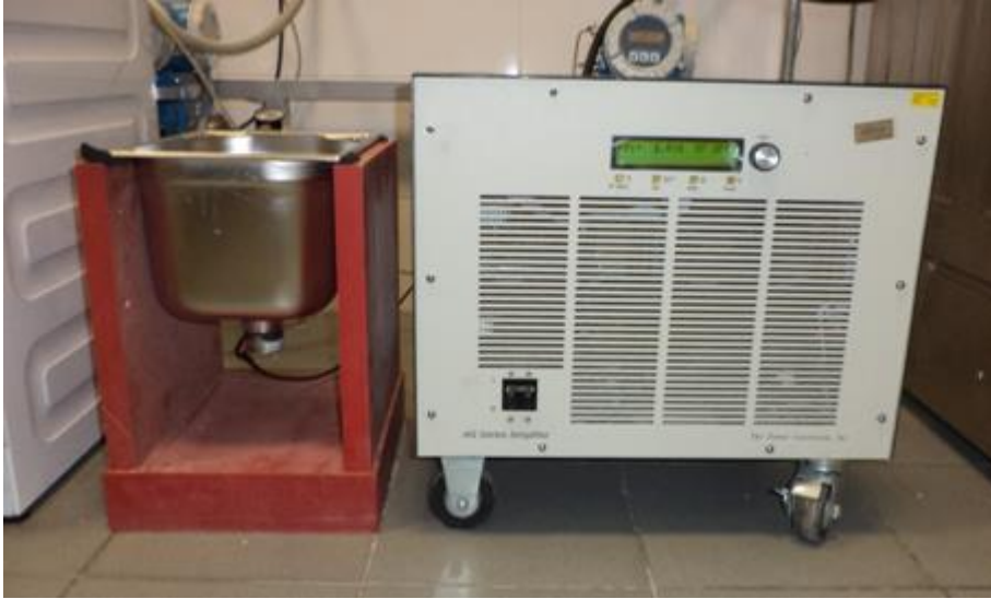
Şekil 3.15 : US ile su dezenfeksiyonu sağlamak için hazırlanan test düzeneği.
