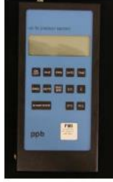
Şekil 3.8 : Kavitasyon enerjisi ölçümü için kullanılan cihaz.
