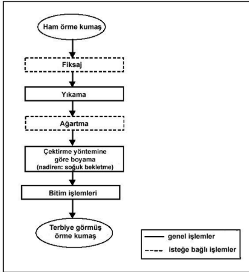
Şekil 2.8 : Daha ziyade sentetik liflerden oluşan örme kumaşların terbiyesi için klasik işlem sırası [1].
