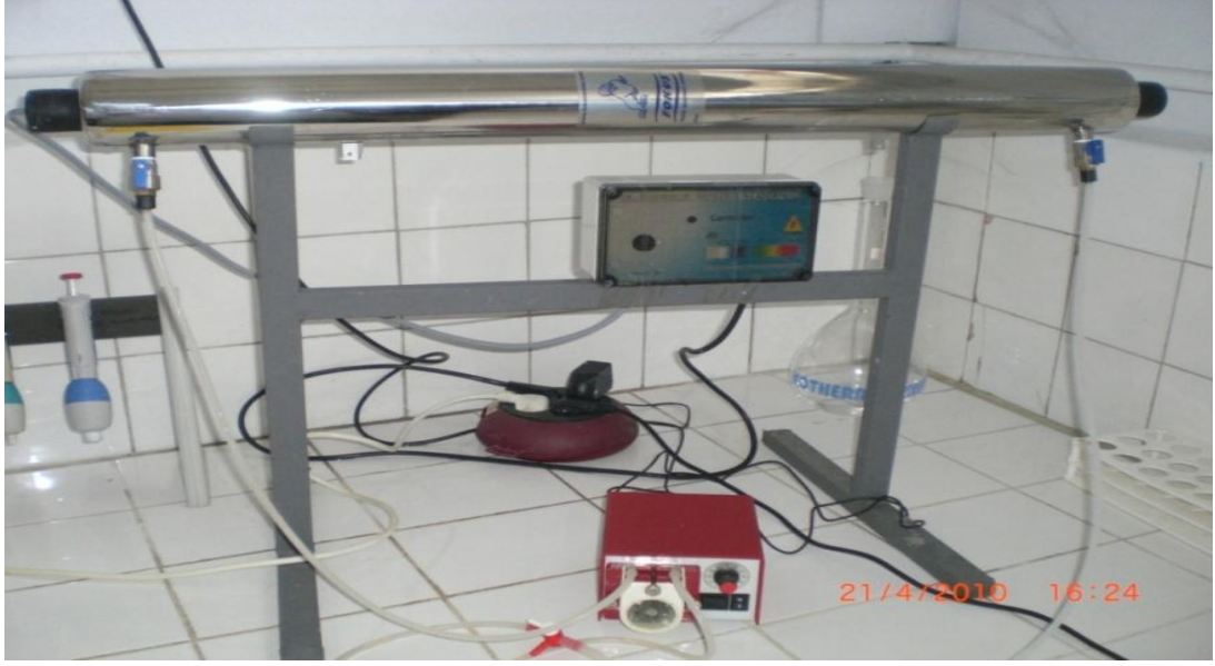
Şekil 3.5 : Fotokimyasal ileri oksidasyon deneylerinde kullanılan UV-C fotoreaktörüne ait görünüm.
