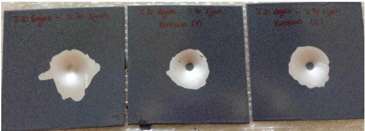
Şekil 6.24: %70 Siyah emaye içeren bileşimin tutunma testi sonucu (kumlama yapılmayan, az kumlama yapılan ve çok kumlama yapılan).
