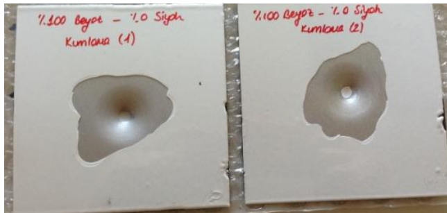
Şekil 6.31: %0 Siyah emayenin tutunma testi sonucu (kumlama yapılmayan, az kumlama yapılan ve çok kumlama yapılan).
