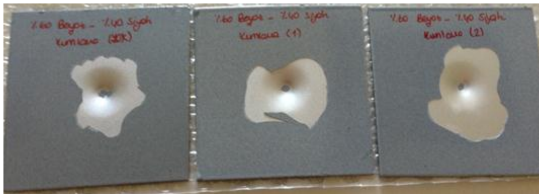
Şekil 6.27: %40 Siyah emayenin tutunma testi sonucu (kumlama yapılmayan, az kumlama yapılan ve çok kumlama yapılan).
