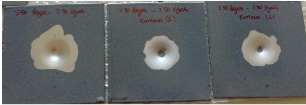
Şekil 6.26: %50 Siyah emayenin tutunma testi sonucu (kumlama yapılmayan, az kumlama yapılan ve çok kumlama yapılan).
