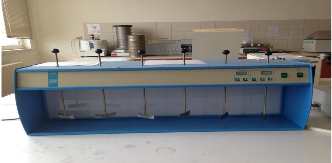
Şekil 8.1. Deneysel Çalışmaların Yürütülmesinde Kullanılan Jar Test Düzenegi
