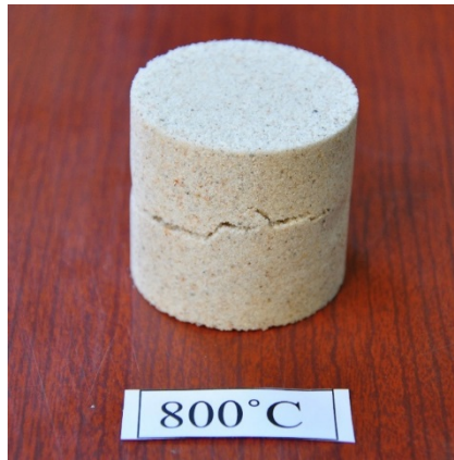
Şekil 6.4: Standart dışı kalmış numune
