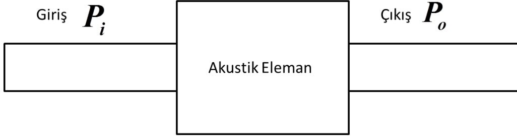
Şekil 1.7: Bir akustik elemanın iletim kaybı.
