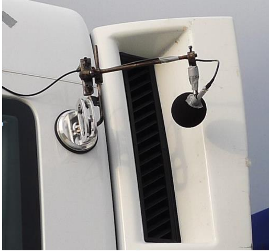
Şekil 3.4: Ölçüm lokasyonuna yerleştirilmiş mikrofon.
