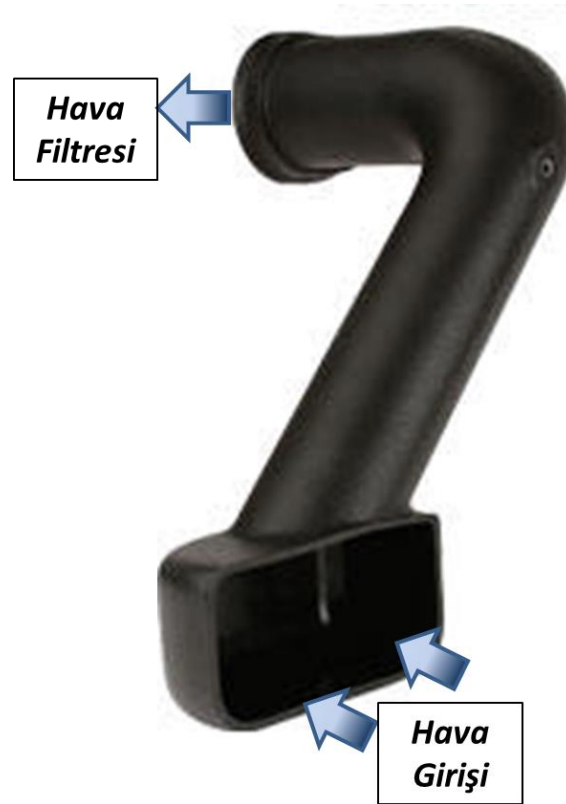
Şekil 1.1: Hava emiş sistemi-Orifis (Kirli Hava Kanalı).
