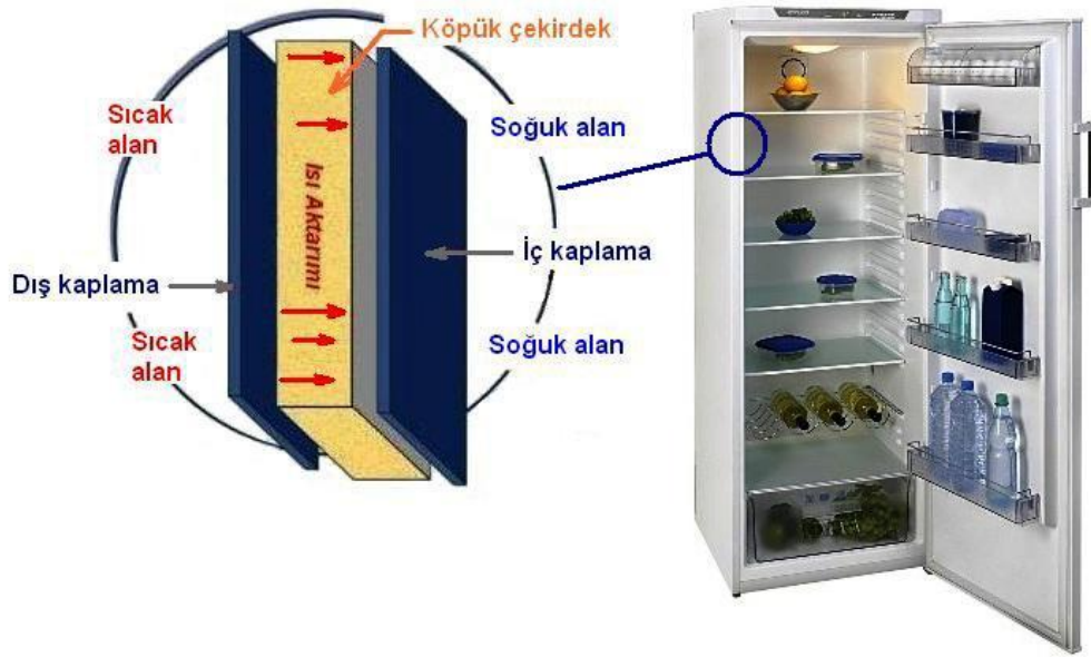
Şekil 4.7 : Buzdolabında Isı transferi.
