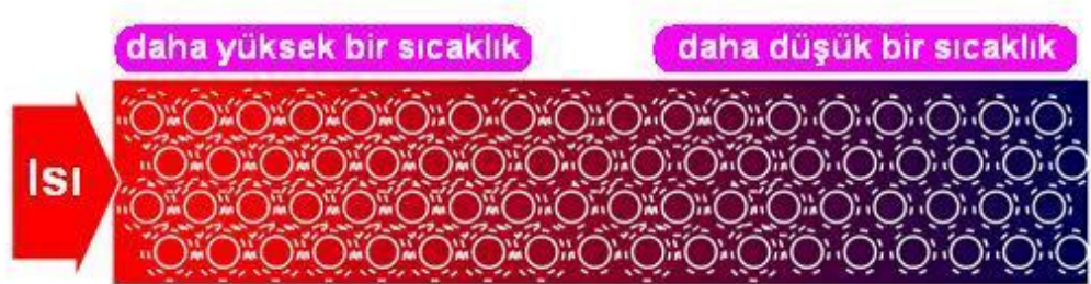
Şekil 3.8 : Katı bir cisimde atomların titreşimi ve ısı aktarımı (Cfbt-us, 2013).
