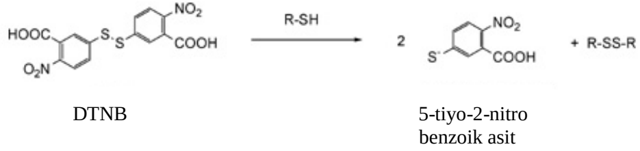
Şekil 2.32: DTNB'nin tiyol grubu bileşik varlığında 5-tiyo-2-nitrobenzoik aside dönüşümü.
