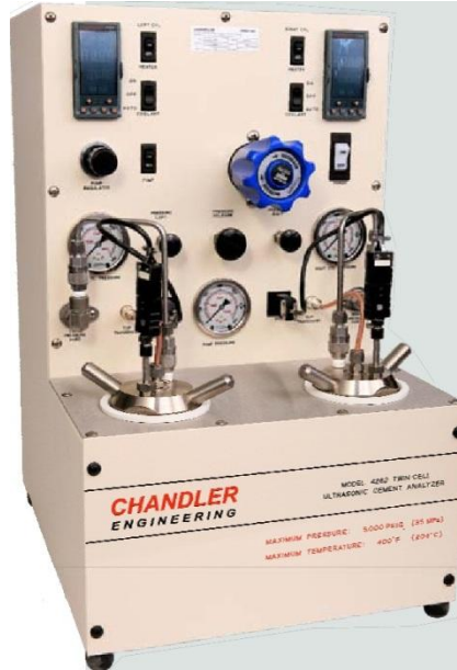
Şekil 4.7: Chandler Firmasının 4262 Model UCA Donanımı – TPAO Araştırma Merkezi.
