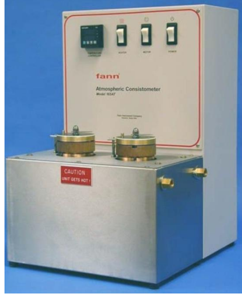
Şekil 4.3: Atmosferik konsistometrenin fotoğrafı.
