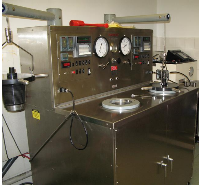
Şekil 4.6: İkiz basınçlı konsistometre – TPAO Araştırma Merkezi.
