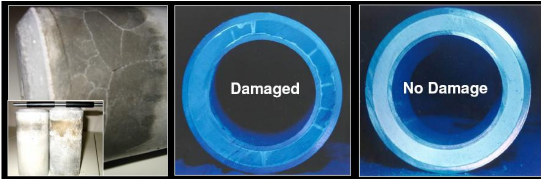
Şekil 2.5: Hasarlı ve hasarsız çimento örneklerinin fotoğrafları [38].
