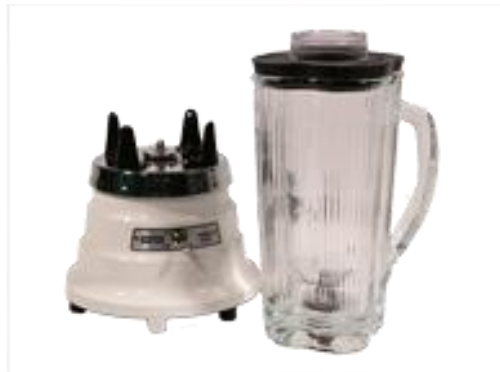
Şekil 4.2: Yüksek hızlı Fann karıştırıcının (blender) fotoğrafı.
