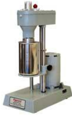
Şekil 4.4: Model 35SA viskometrenin fotoğrafı.
