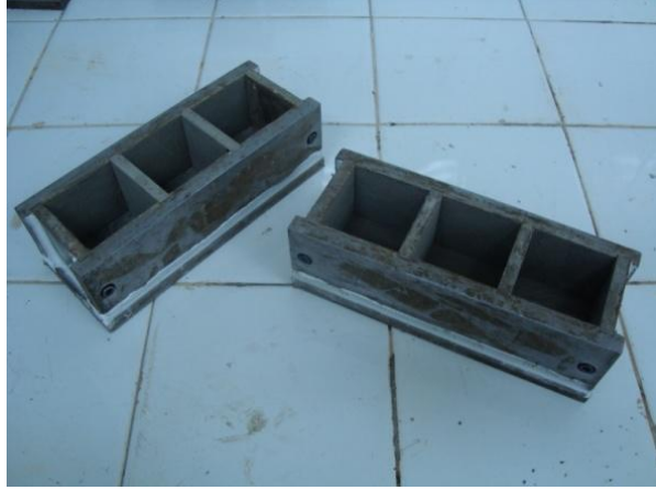
Şekil 4.10: Deneylerde kullanılan küp kalıplar.
