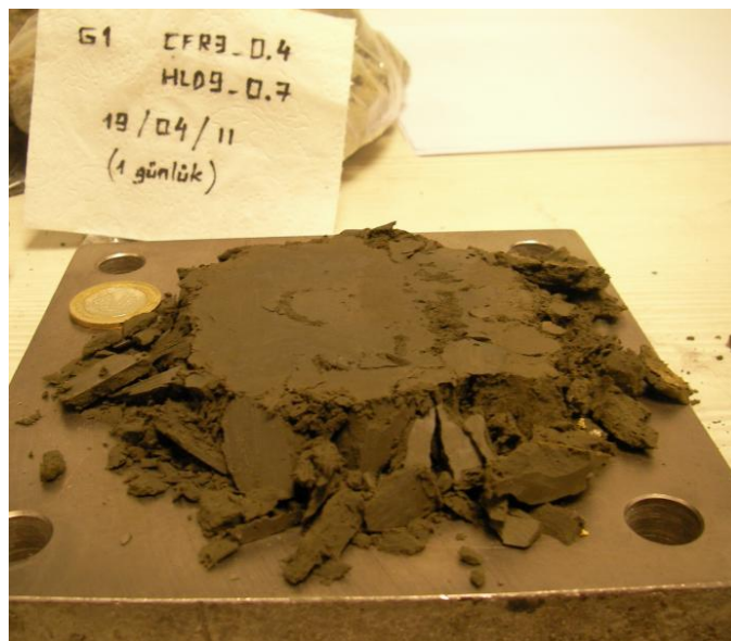
Şekil 6.2: Sünekleşmiş çimento örneği.
