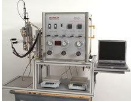
Şekil 4.14: Gaz göçü analizörü (GMA).
