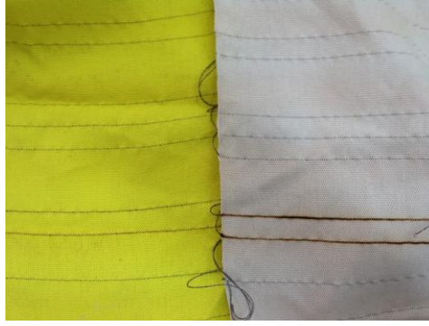
Şekil 5.12: Gerilim sonucu zarar görmüş kumaşların görüntüsü.
