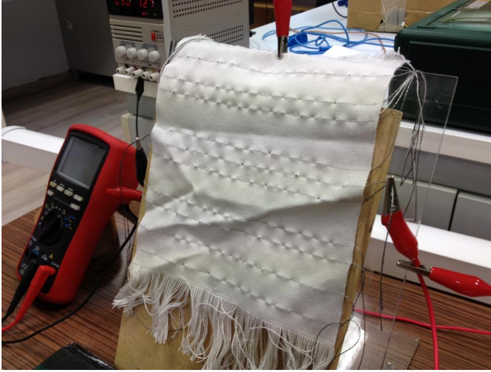
Şekil 5.5: DC güç kaynağının iletken ipliklere bağlanması.
