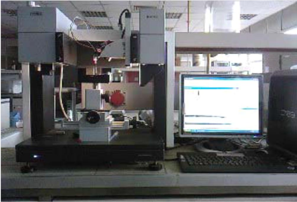
Resim 5.1. DSA100 Temas açısı ölçüm cihazı
