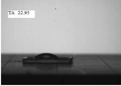
Resim1.1. %2 CeO 2 /TEOS ile kaplanan cam yüzeyin temas açısı
