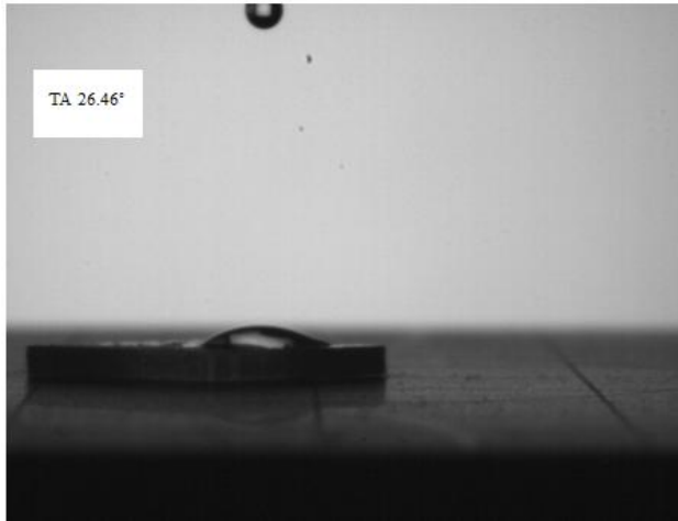
Resim 6.6. %10 \text{Cr}(\text{NO}_3)_6/\text{TEOS} ile kaplanan cam yüzeyin temas açısı
