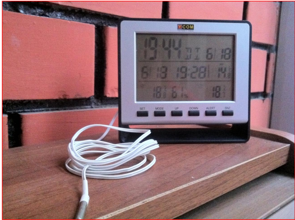
Şekil 3.3. Araştırmada kullanılan YCOM – KMN 305 iç/dış ısı ve nemölçer cihaz
