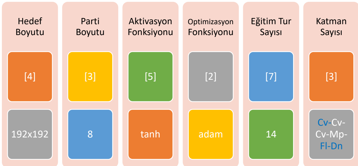
Şekil 35. KES-DAL-CNN9 mimari yapısı ve hiperparametreleri (6. Sütunda yer alan Cv, Fl ve Dn katmanları sabit katman olduğu için mavi ile renklendirilmiştir. Sabit ve giriş-çıkış katmanları dahil toplam 8 katmanlıdır. Cv: Convolution, Ap: AveragePooling, Dr: Dropout, Mp: MaxPooling).
