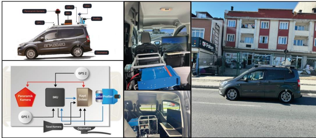
Şekil 3.2 : LiDAR’lı MHS aracı ve sistemin şematik görüntüsü, araç içi donanımlar ve sahadaki ölçme esnasındaki görüntüsü.
