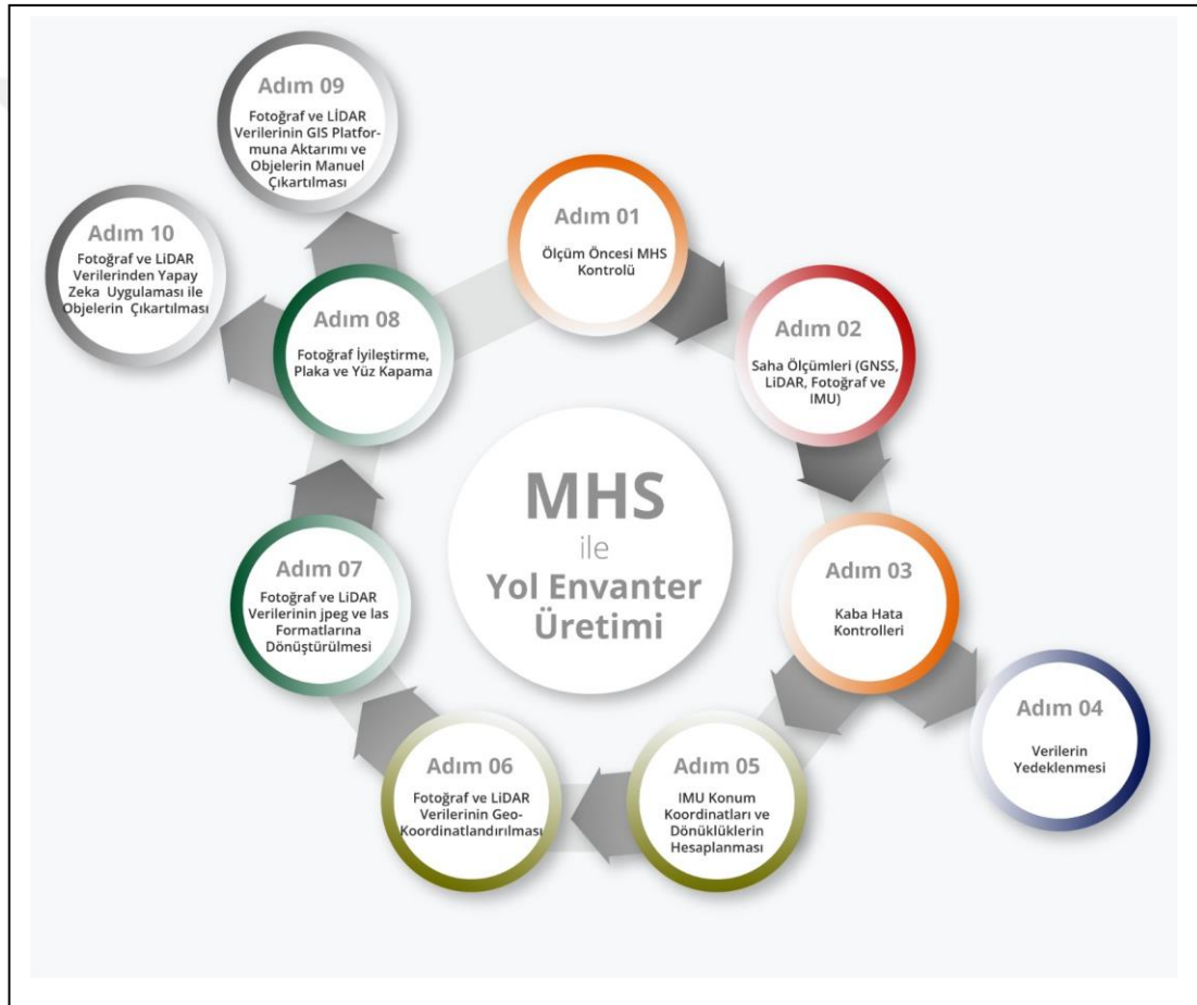
Şekil 3.4 : MHS'nin sahadan veri toplama sürecinden objelerin detekte edilme süreci.
