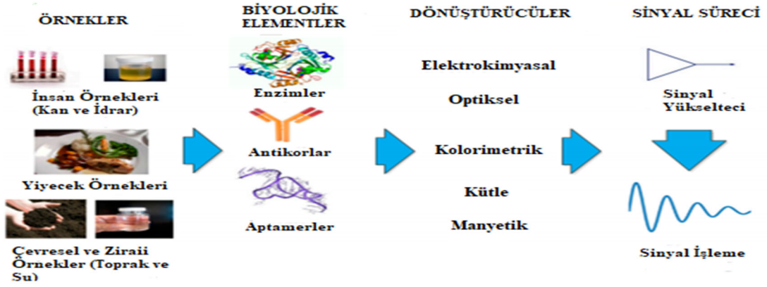
Şekil 2.3: Biyolojik tanıma elemanları, dönüştürücüler ve bir sensörün farklı bölümlerinin şeması [38].
