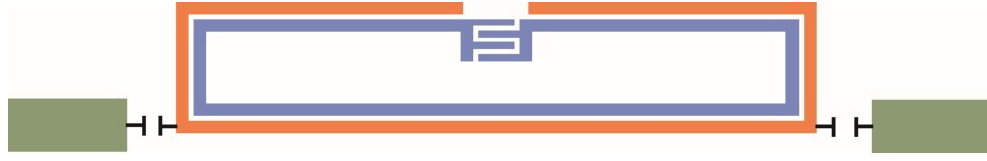
Şekil 3.2. Eş yönlü ayırık halka rezonatör devre tasarımı
