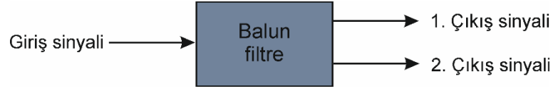
Şekil 2.3. Balun filtrelerin blok şeması
