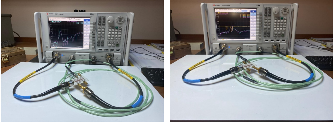
Şekil 5.2. İmal edilen çok kanallı mikroşerit balun-çiftleyicinin ölçüm anına ait fotoğrafları
