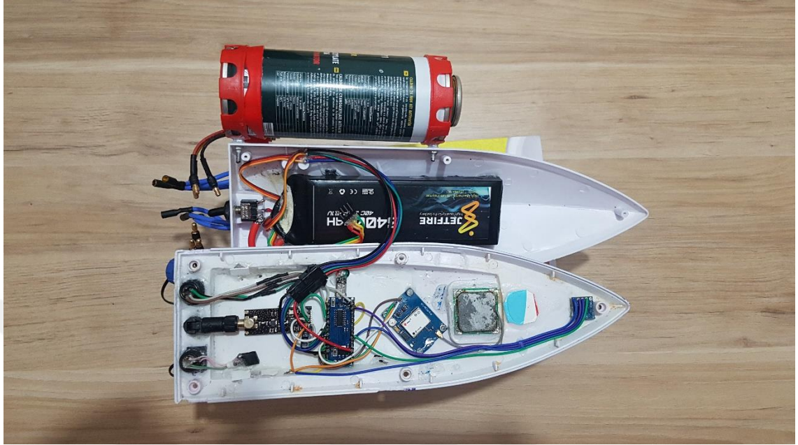
Şekil 4.7: Tasarlanan İSÜA' nın iç yapısının görünümü.
