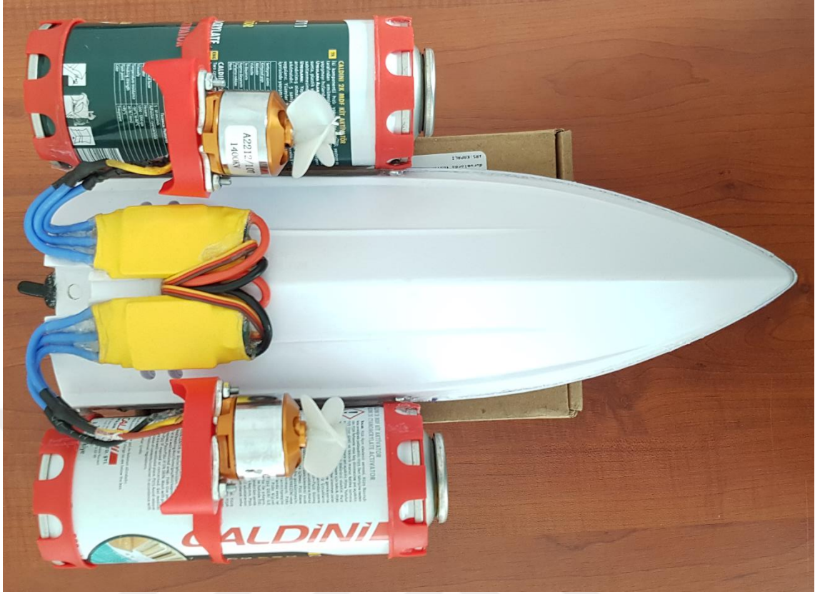
Şekil 4.6: Tasarlanan İSÜA' nın alt gövdesi.
