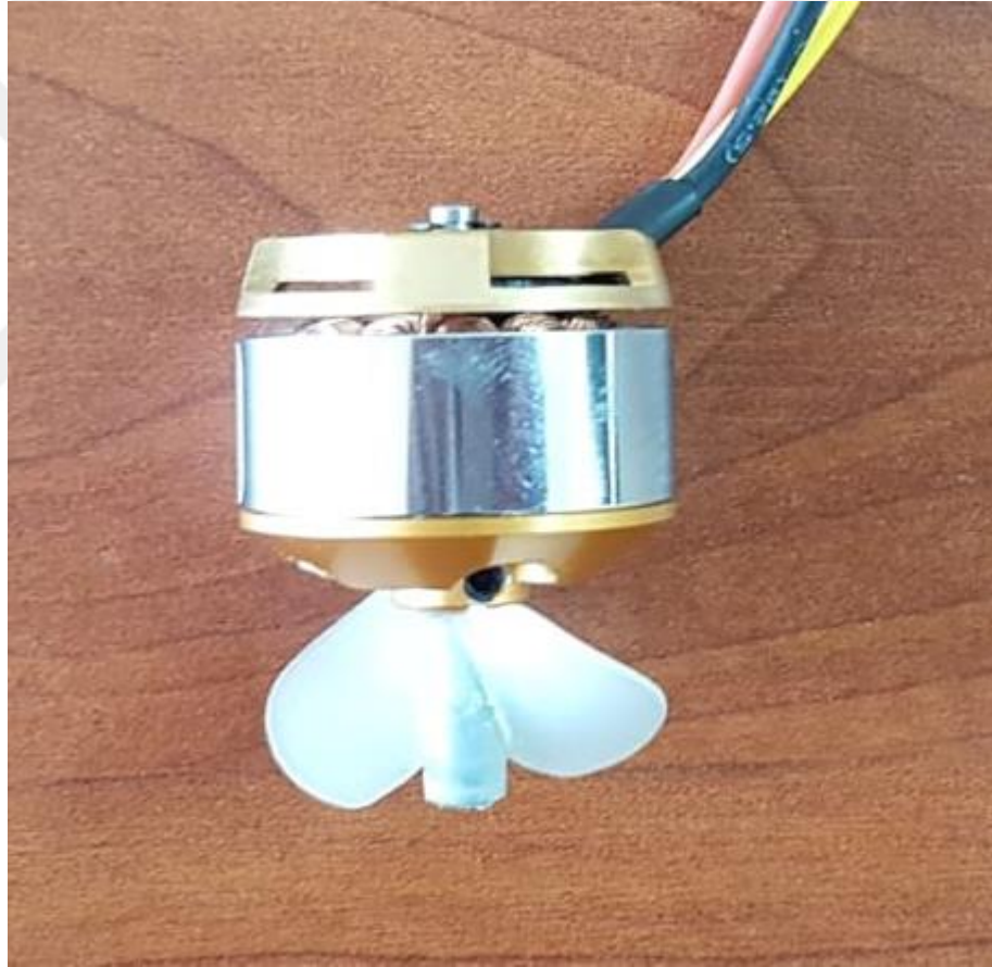
Şekil 4.1: Yüksek devirli fırçasız motor ve pervanesi.
