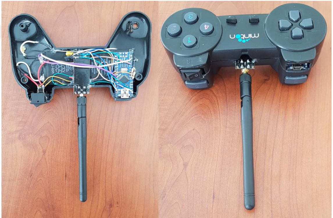
Şekil 4.15: Tasarlanan İSÜA' nın kumanda ve harici bilgisayar ile haberleşme sistemi.
