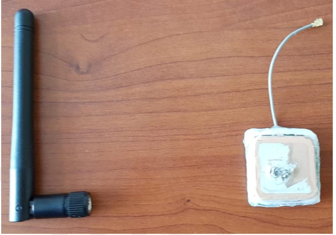
Şekil 4.4: Kablosuz haberleşme için kullanılan harici antenler.
