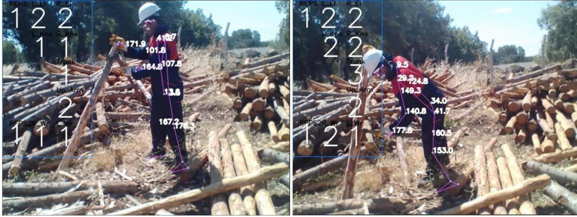
Şekil 3.3. Gerçek zamanlı REBA değerleri ve vücut eklem açılarında ait puanların örnek ekran görüntüsü
