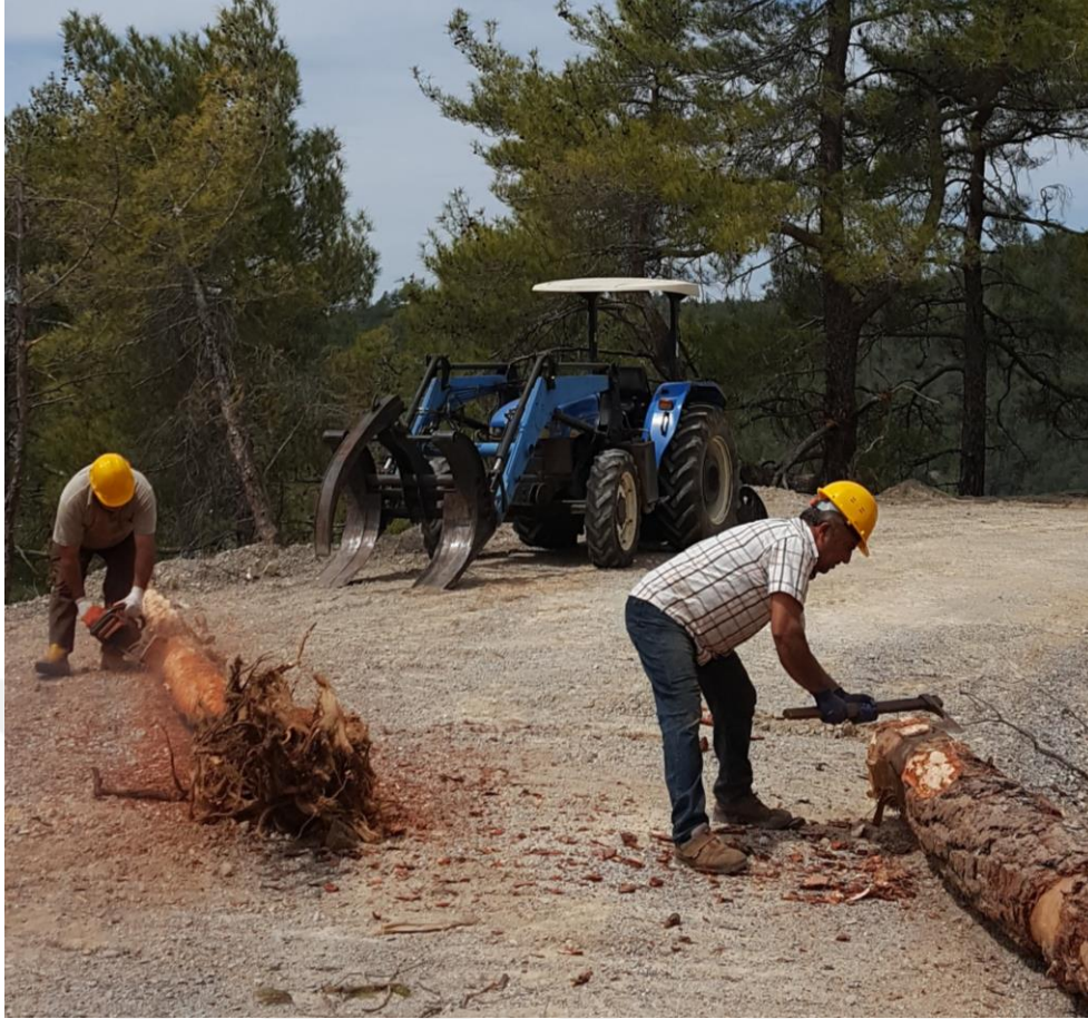
Şekil 1.3. Kabuk soyma aparatı (sol) ve balta (sağ) ile kabuk soyma (Foto: N. Gülci)
